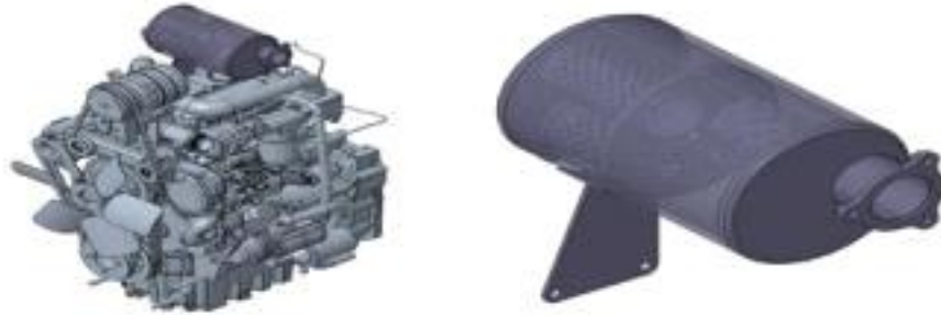
그림 14. T653 트랙터에 사용된 Perkins사의 1103C-33T 엔진의 Layout 및 소음기 형상
