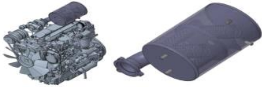
그림 16. T1003 트랙터에 사용된 1104D-44TA 엔진의 Layout 및 소음기 형상
