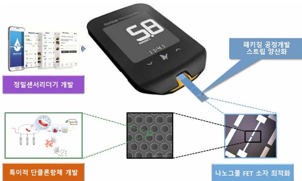
[그림 1] 휴대용 ASF 바이러스 진단키트 개념도
