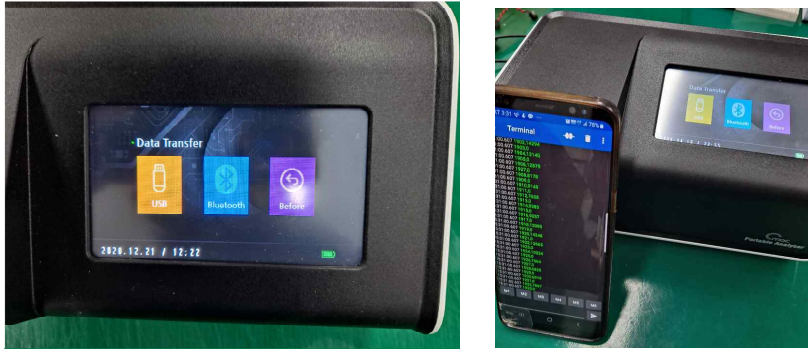
[그림 43] 블루투스 통신을 통한 데이터 전송 및 확인
