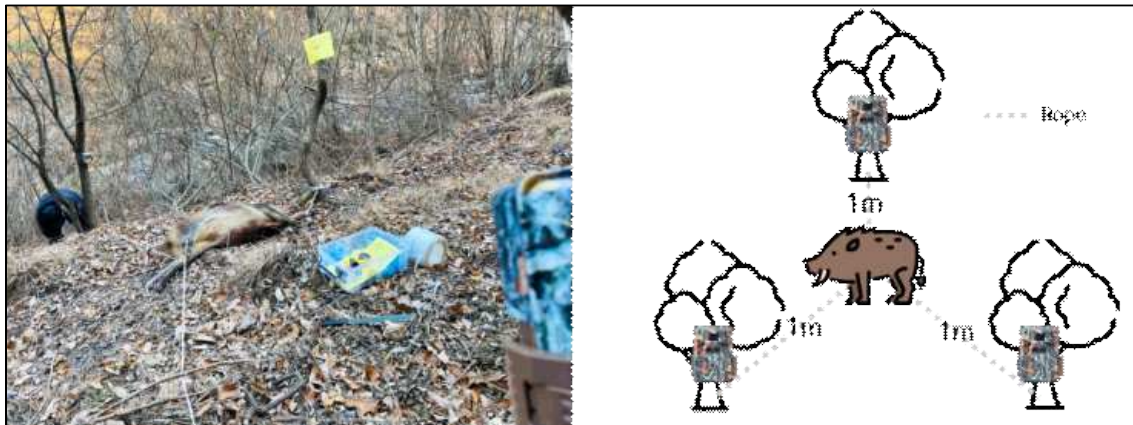
그림 2.77. 설치된 3대의 센서 카메라(좌)와 센서카메라 모식도(우).
