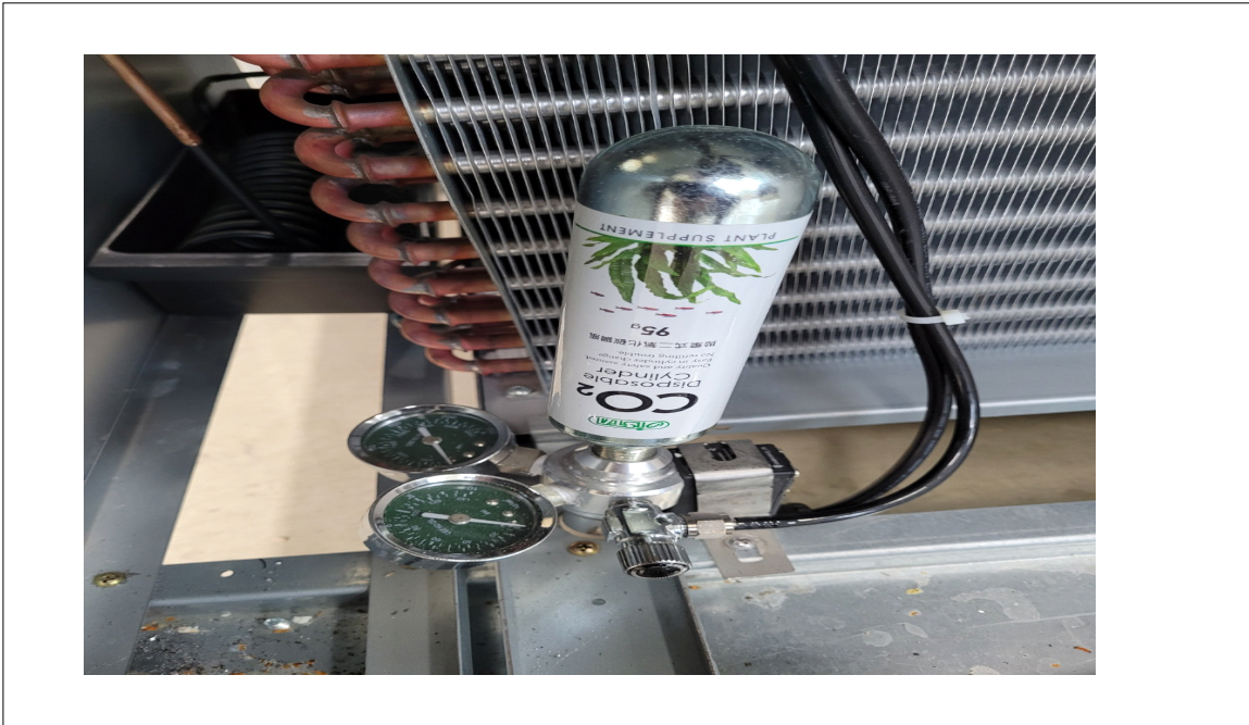
<그림> 실내용 재배기 열교환실내 위치한 CO 2 장치
