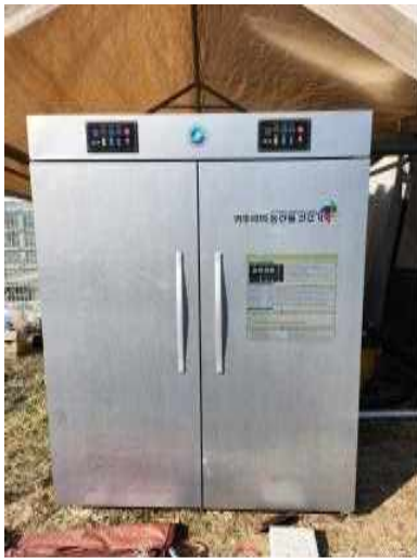
그림 2-49. 농산부산물 반탄화 연료 건조장치 설치 사진
