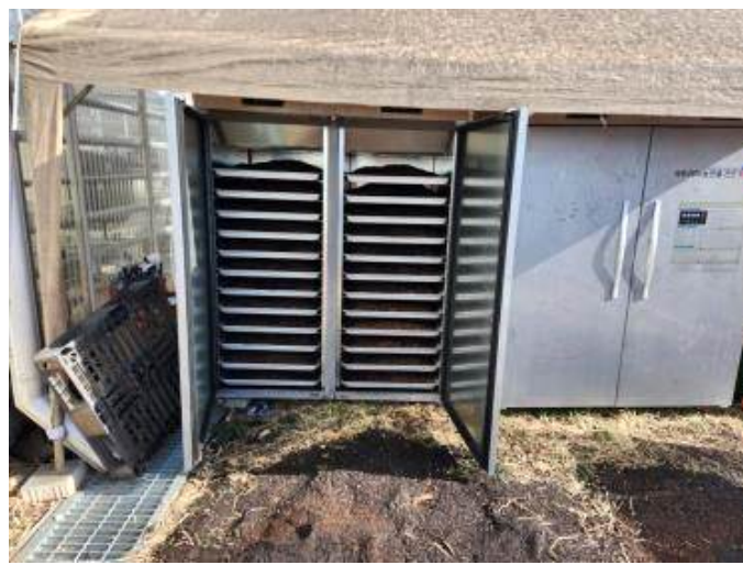
그림 2-49. 농산부산물 반탄화 연료 건조장치 설치 사진
