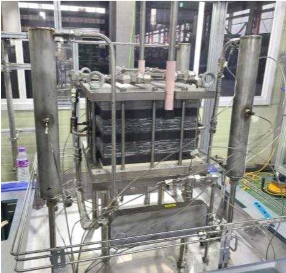
그림 1-33 H-BOP 내부 스택 및 제작품
