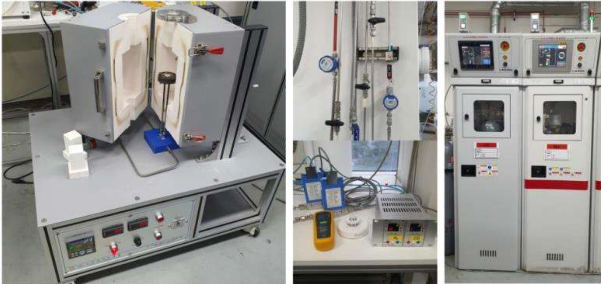
[그림 4-1 (좌) 혼합연료 SOFC 테스트 스테이션, (중) 일산화탄소&수소 가스라인 및 MFC와 컨트롤러, 일산화탄소 경보기 및 검출기, (우) 일산화탄소&수소 안전 가스 캐비닛 설치 사진]
