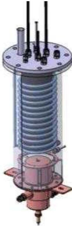
그림 1-16. 연료전지 시스템용 개질기 3D Modeling
