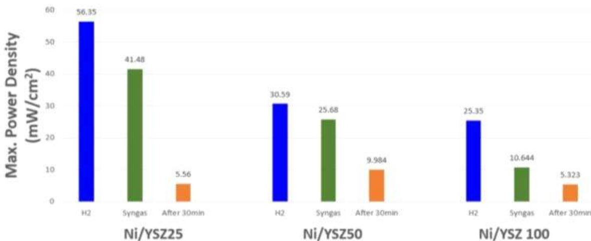
[그림 4-9 세가지 비율의 Ni-YSZ 박막 연료극이 도입된 ESC SOFC의 750°C 일산화탄소-수소 혼합가스 작동시의 성능 및 열화 비율 비교 결과]
