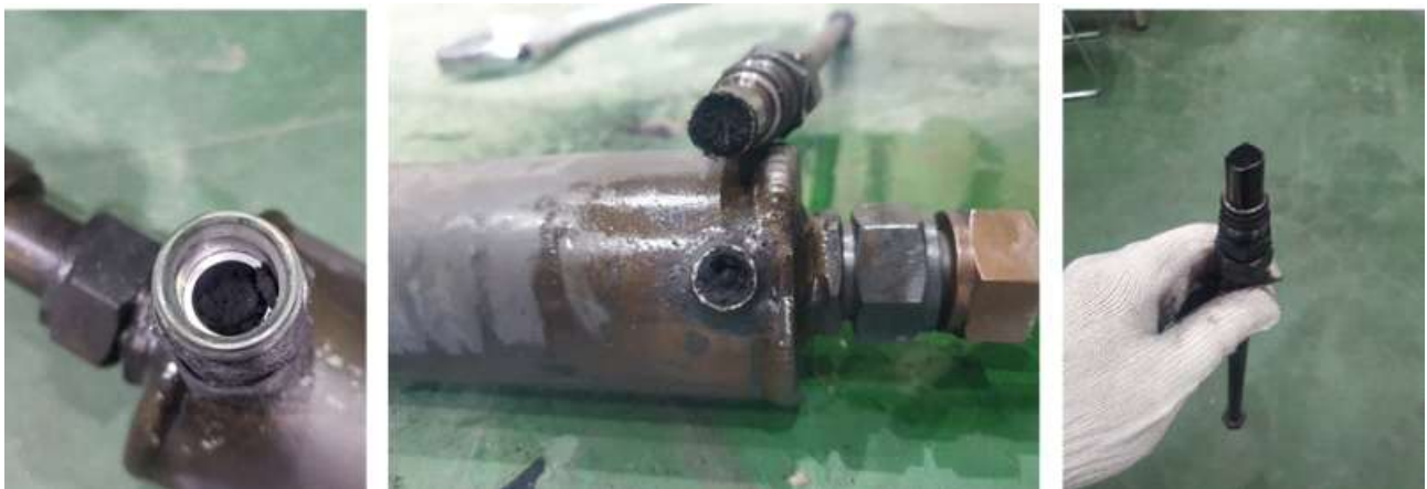
그림 1-47 탄소 코킹현상으로 배관 막힘 현상 발생
