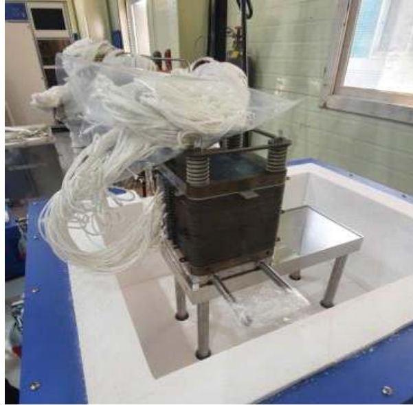
그림 1-25. 연료전지 시스템 Furnace 내부 스택 체결
