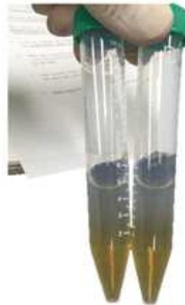
4. 용액을 식힌 후 5 mL hexane, 3 mL aliquot of distilled water 를 넣고 phase separation이 되게 상온에 정치
