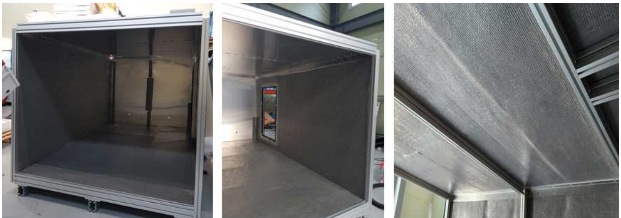
그림 12 모사 컨테이너 제작 (내부 VIP 시공)
