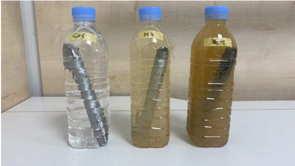
그림 38. 배관 부식 실험 육안 평가 (배관 샘플 - Sus 배관/ 백관/ 흑관)
