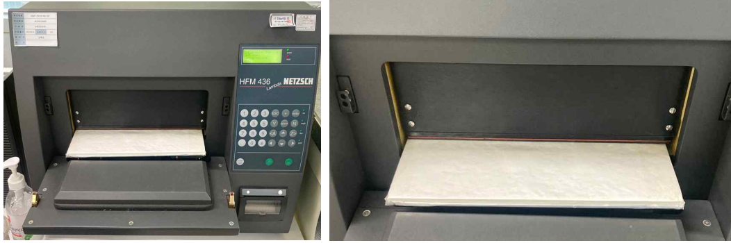
[그림] Heat flow meter를 이용한 진공단열재(소형)의 정밀 성능 측정
