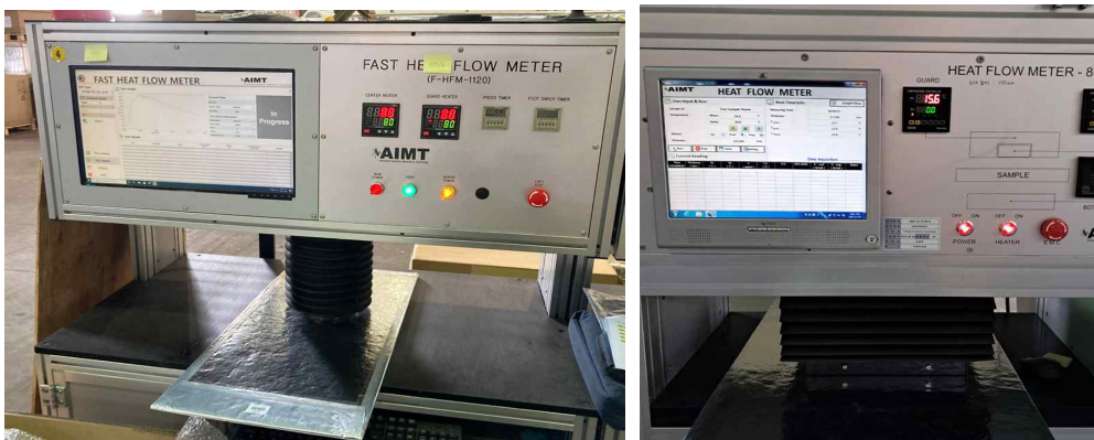
[그림] 쾌속측정기와 대면적 측정기를 이용한 진공단열재(대형)의 성능 측정
