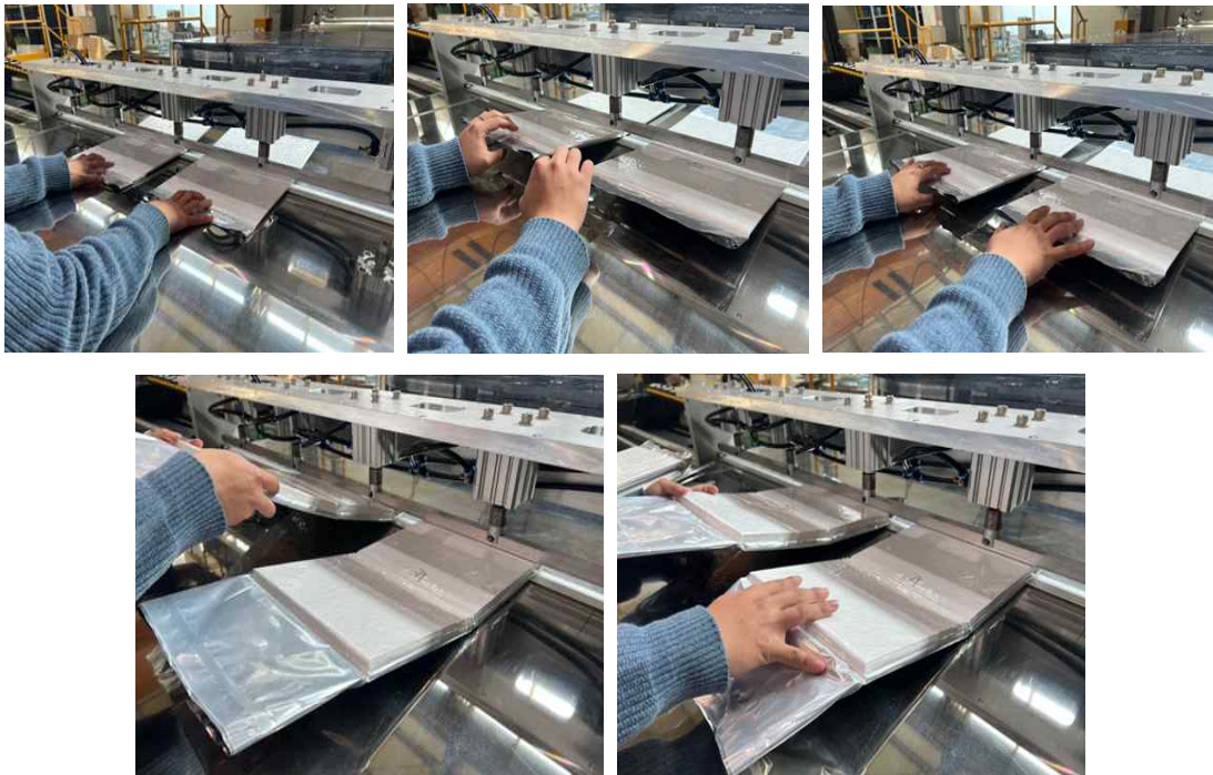
[그림] 절곡 지그를 이용한 진공단열재 절곡 과정
