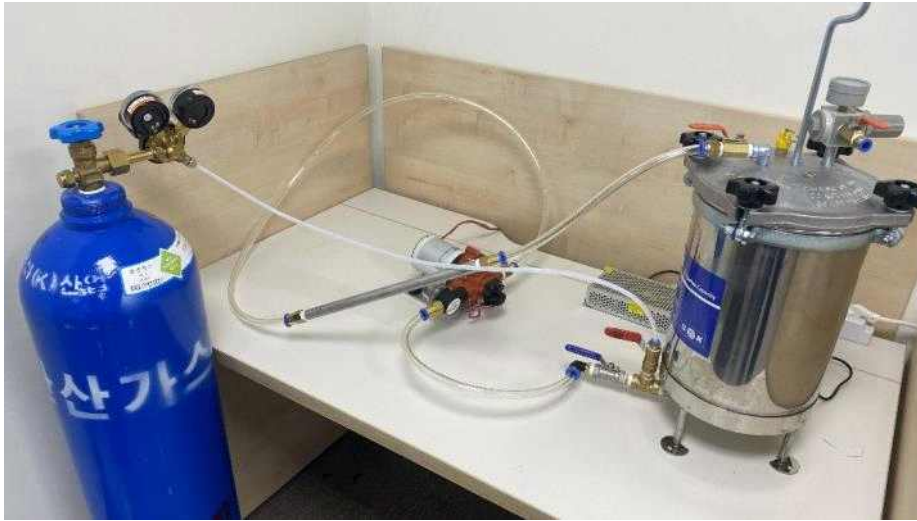
그림 37. 배관 부식 실험 장치 구성 (순환)
