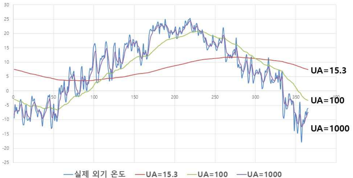
그림 8 UA(열관류율 x 면적)값에 따른 수온 변화 그래프 (실제 외기 온도 반영)
