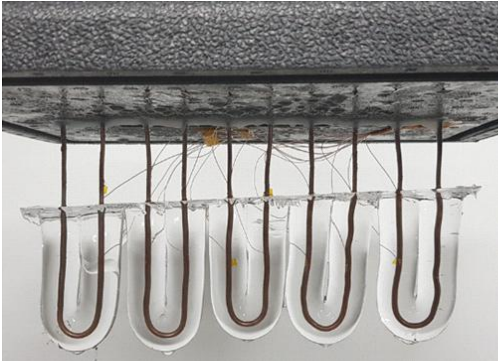
[그림] OHP 자연냉열 생산을 통한 고온부(증발부) 표면 ice 생성
