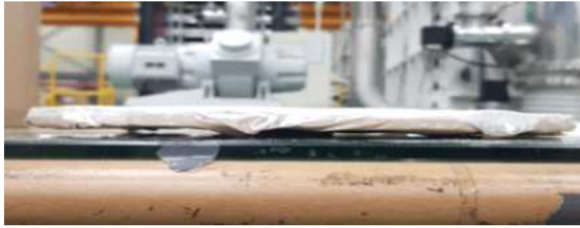
[그림] 외피재의 중첩으로 표면(바닥)의 편평도가 저하된 모습
