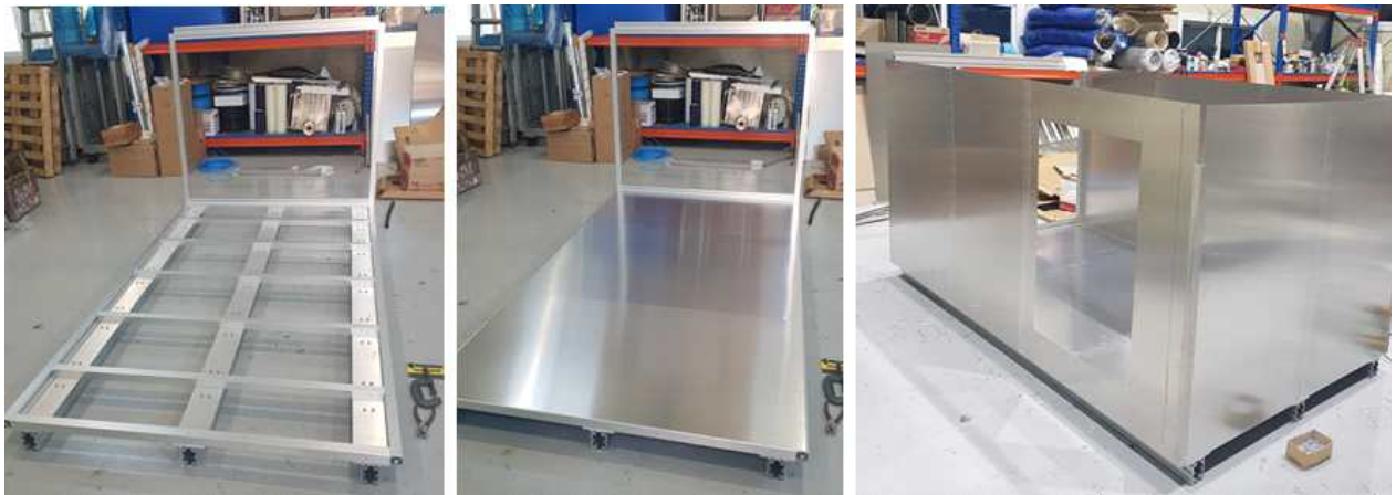
그림 11 모사 컨테이너 제작 (외형 프레임 제작)
