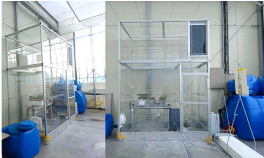
[그림 6. 냉방/환기 챔버 온실 설치 사진(KIST 자체 실증 온실)]
