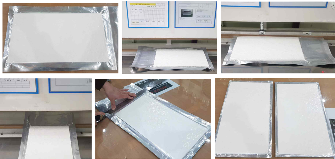
[그림] 심재 4개의 모서리를 2차 열융착 한 후, 필름의 여유부를 재단하는 과정 (사각)
