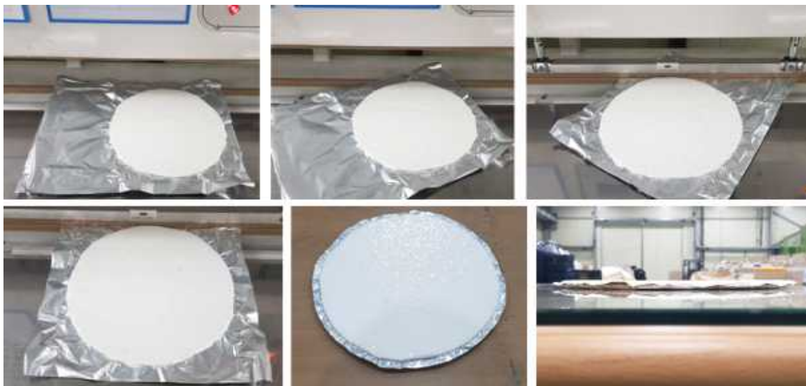
[그림] 원형 모서리를 2차 열융착 한 후, 필름 여유부를 재단하는 공정 (원형 VIP)
