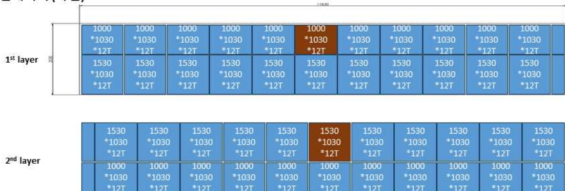
그림 23 각 layer에서 파손된 VIP가 서로 겹쳐진 상황 가정 (빨간색 표시)
