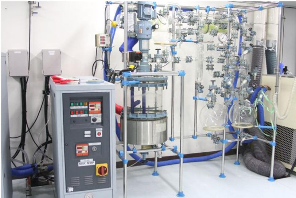
그림 42. 50 Liter 저온 분별 결정화 반응기 사진(저온 분별화 장치 : 한국 화학연구원)
