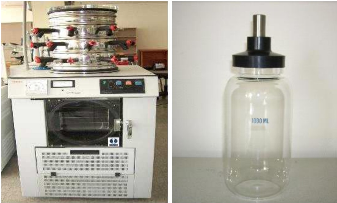
Fig 85. 구아바 발효농축물의 동결건조기 및 tray.
