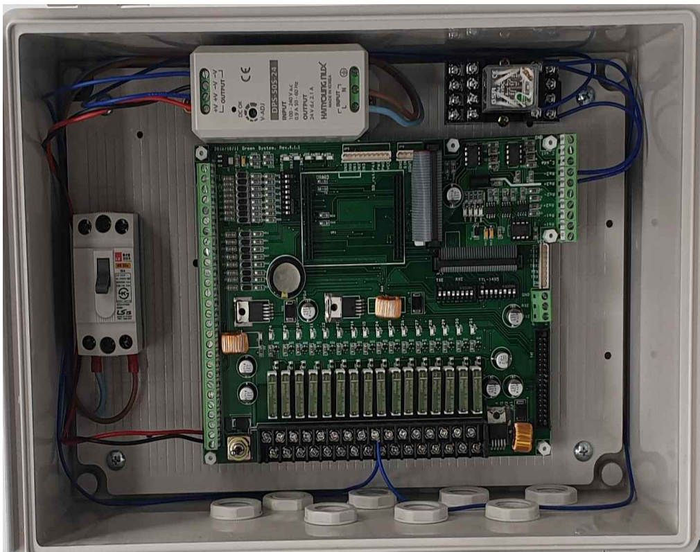
그림 . 약용작물 스마트팜의 표준 센서/구동기 노드
