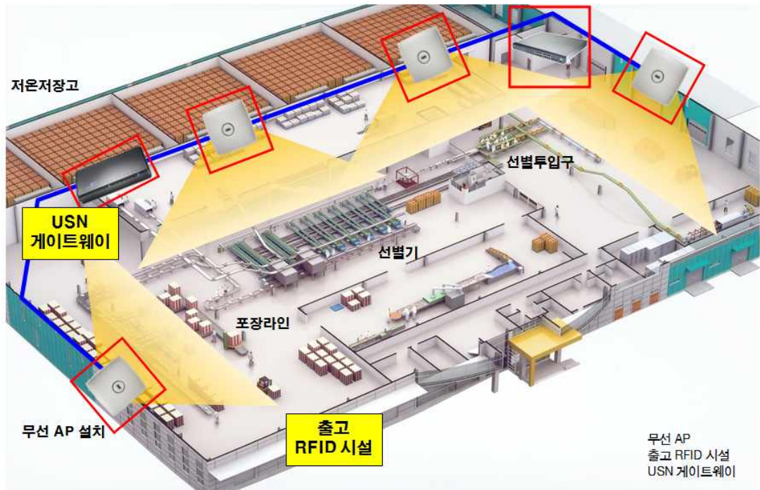
<그림 209> 예상 설치 장소 및 장치
