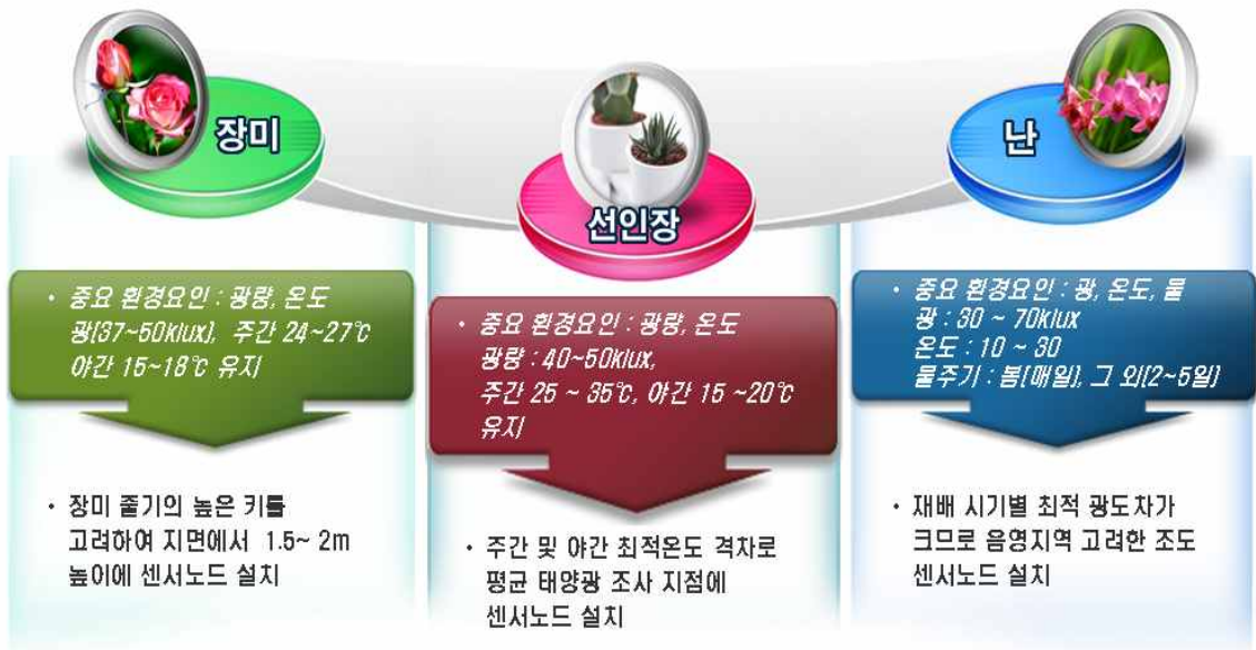
<그림 50> 화훼 품목별 재배조건과 센서노드 설치내역
