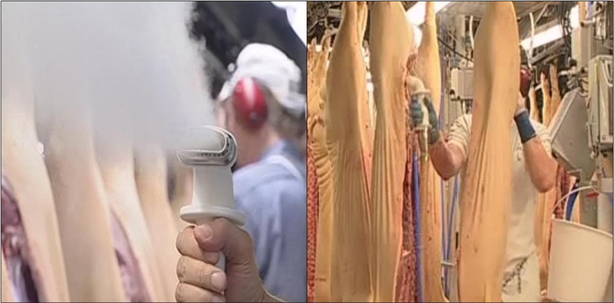
그림. 22. Steam Vacuumsteaming 기계를 이용한 오염물질 제거
