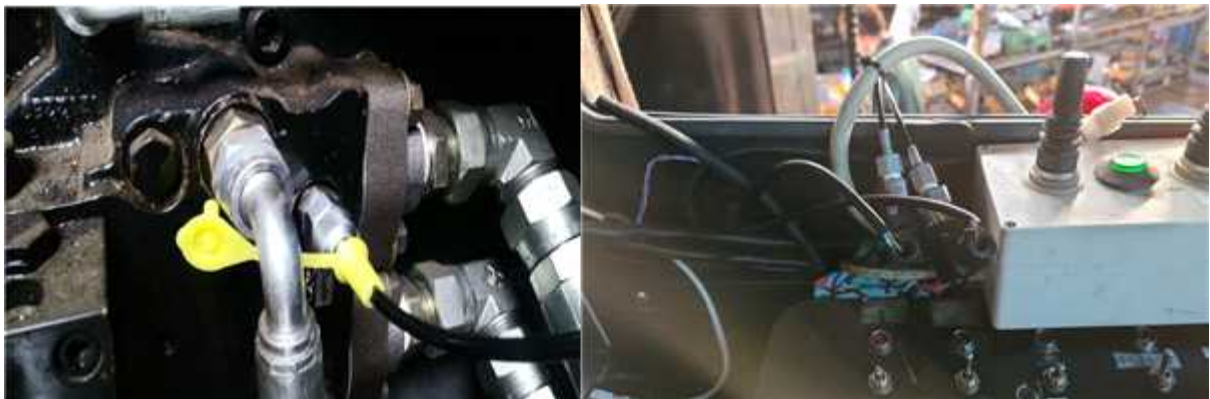
그림. 유압 모터에서 라인을 연결한 사진(좌), 주행부 유압센서를 설치한 사진(우)
