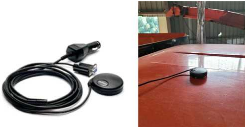
그림. 자주식 일관 작업기 캐빈 위에 설치된 GPS
