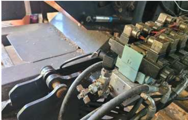
그림. 랩핑부 유압센서를 설치한 사진
