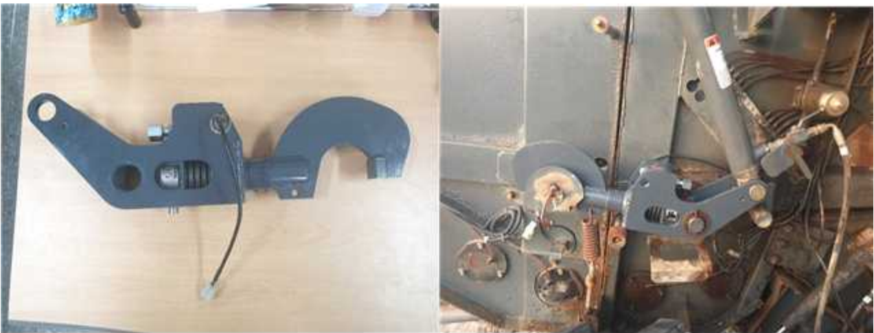
그림. 로드셀을 설치한 후방 챔버 개폐 후크 제작 사진(좌) 및 베일리에 장착한 사진(우)
