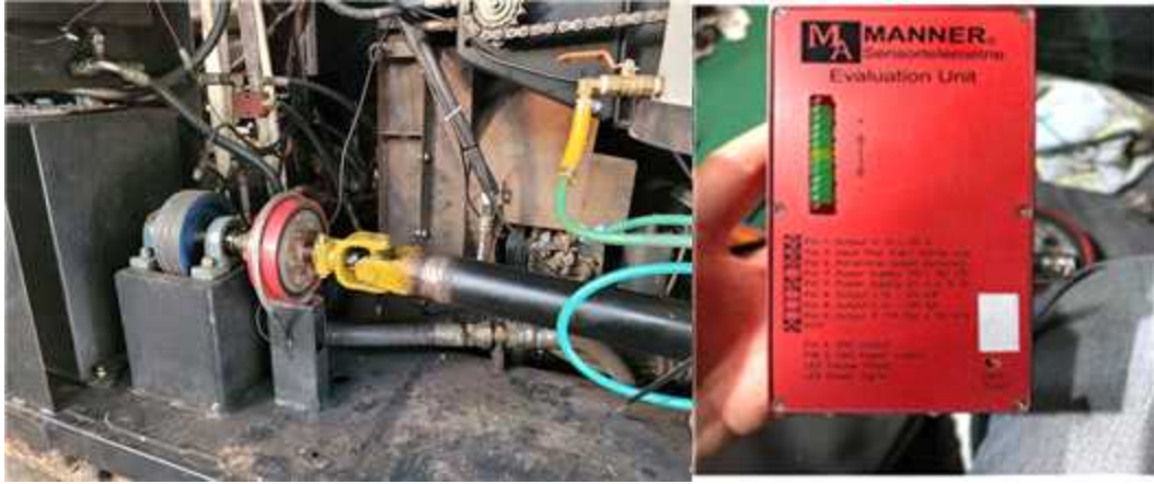
그림. 베일러 축 PTO 토크미터 부착 사진(좌), PTO 토크미터 Amplifier(우)
