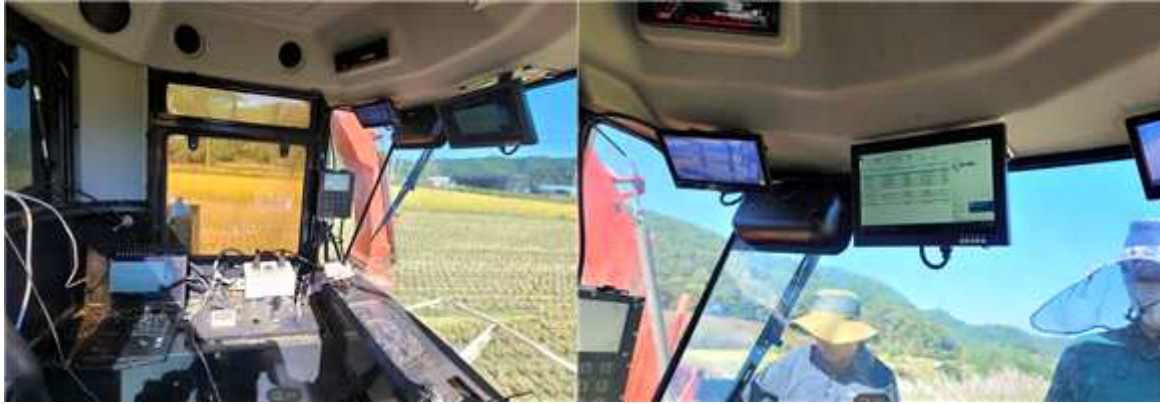
그림. 자주식 일관 작업기 내부에 설치된 부하 데이터 수집용 컴퓨터 및 모니터
