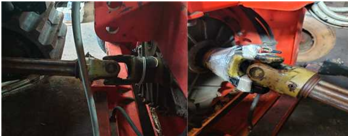
그림. 하베스터 PTO축 스트레인 게이지 부착 사진
