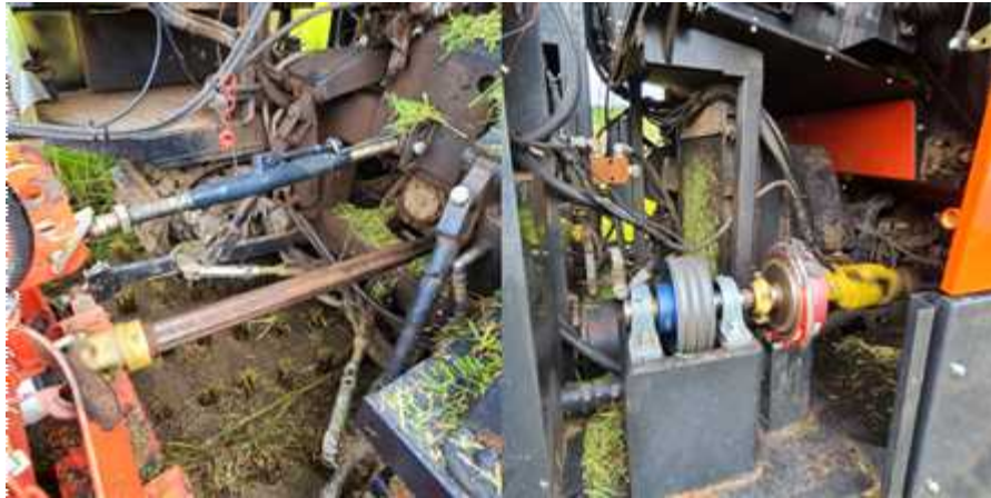
설치된 토크미터 및 하베스터 계측 센서
