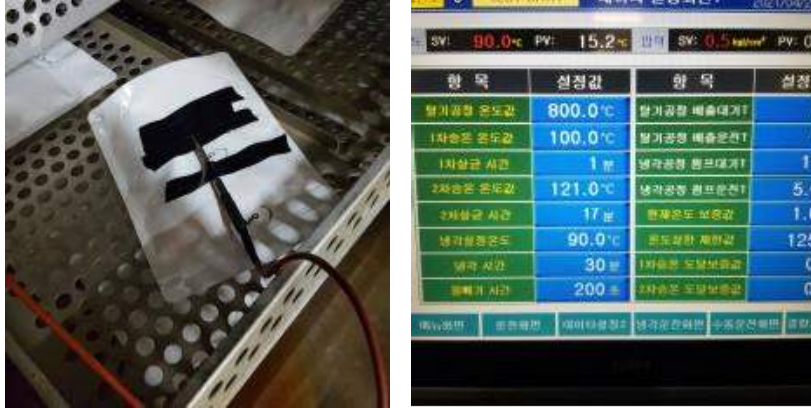
Figure 2-30. 상온연하식 레토르트 공정 실험 사진.
