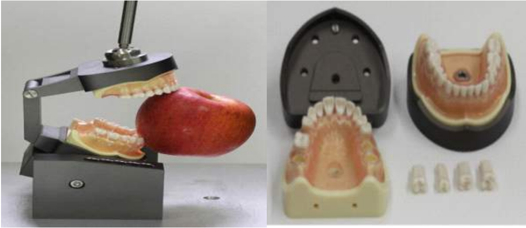
Figure 4-7. 물성 분석용 치아 측정 기구 : 인간의 치아 및 저작운동을 모사한 3D 저작 모사 시스템 개발 (출처 : 한국식품연구원, 2020)
