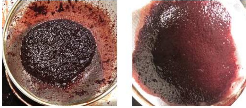
그림 25. 일반 분쇄용 분쇄날을 이용하여 응고혈을 분쇄시킨 결과 (좌)와 미분쇄용 분쇄날을 이용하여 응고혈을 분쇄시킨 결과 (우)
