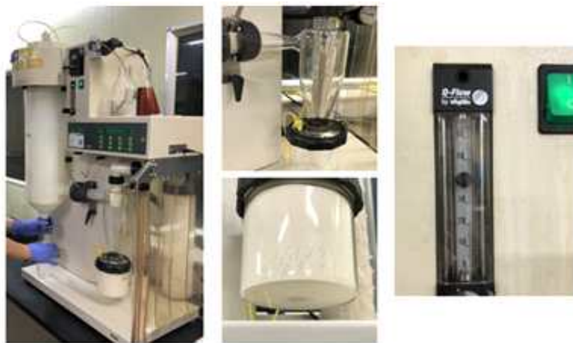
그림 49. 소형분무건조기를 이용한 소재의 분무건조
