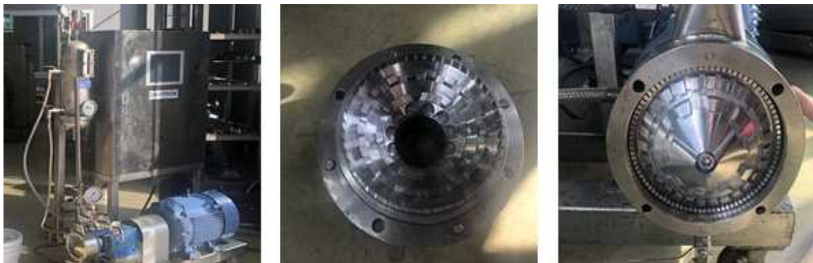
그림 22. 콜로이드 밀과 콜로이드 밀의 일반 분쇄용 분쇄날 (고정분쇄날 (중간), 회전분쇄날 (우))
