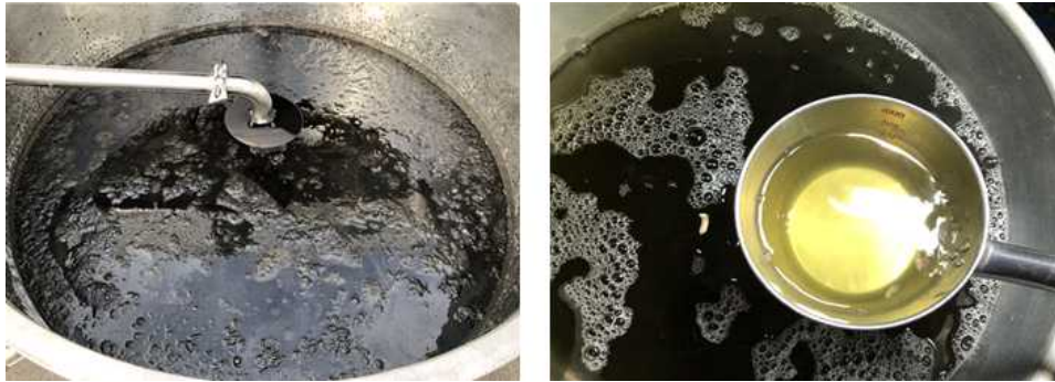
그림 45. 누체 필터를 이용한 활성탄 여과
