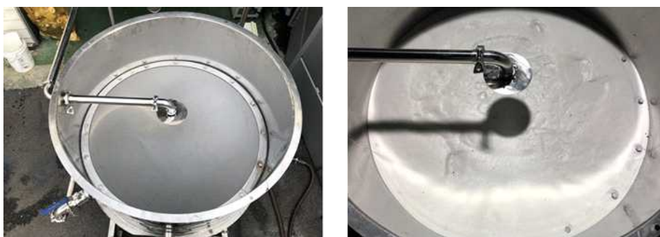
그림 44. 규조토를 이용한 누체 필터 제작
