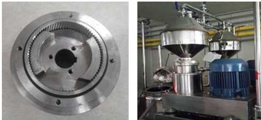
그림 21. 빗살무늬 다중 커터날 (좌)과 이를 이용한 응고혈 분쇄기 (우)
