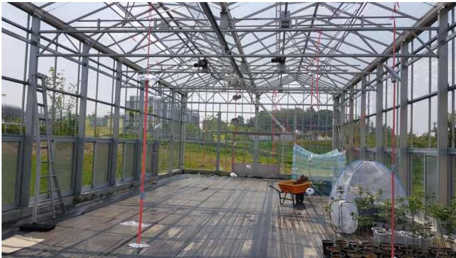
공기순환 팬을 이용한 온도변화 시험 온실
