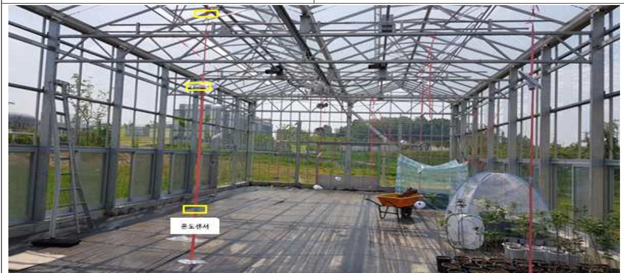
공기순환 팬을 이용한 온도변화 시험 온실
