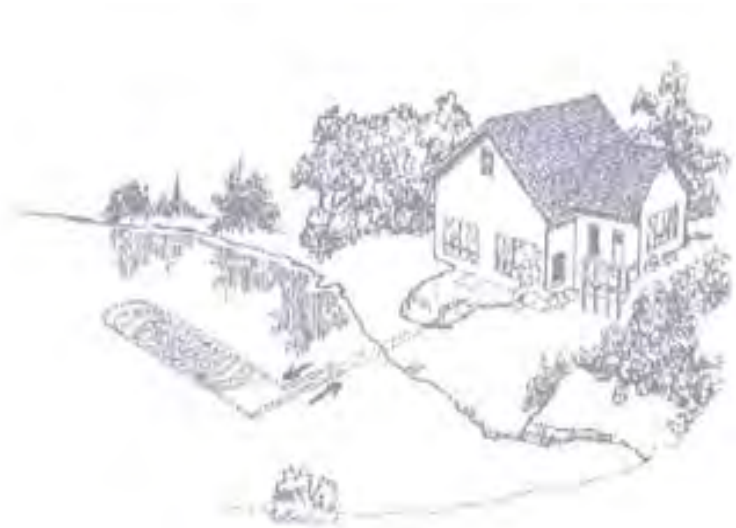
[그림 2-558] 지표수 열원 히트펌프 시스템
