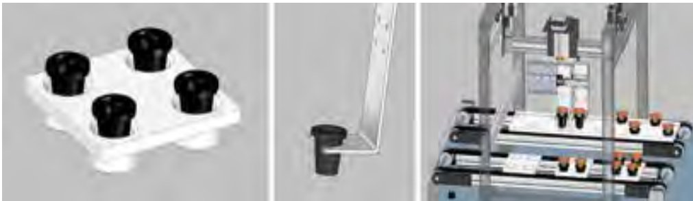
[그림 2-1221] 포트, 베드, 포트 그리퍼 기본구조 설계 - 로보게이트
