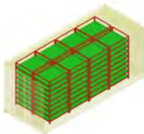
[그림 2-222] 컨테이너 육묘기 설치 개념도
