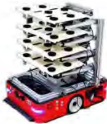
[그림 2-1245] 회전식 자동거치대형 스마트팜 전용 AGV, 로보게이트
