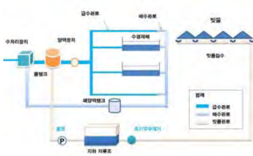
[그림 2-35] 스마트팜 물이용 시스템 구성
