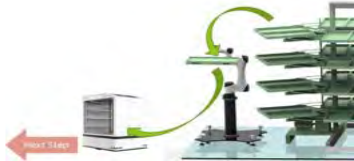
[그림 2-1175] 로봇팔, AGV를 통한 자동화 공정연계 - 수경재배자동화라인에서 수확공정
