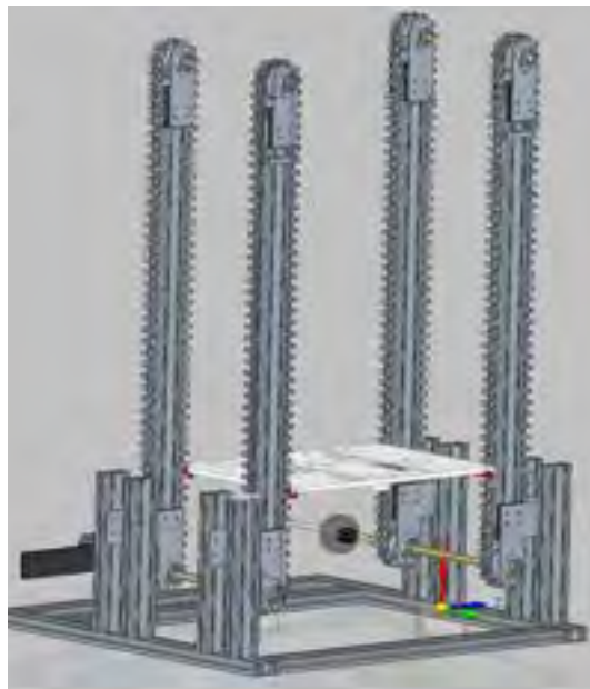
[그림 2-1130] 수직형 컨베이어벨트 시스템의 컨셉 연구 및 3D 설계 2
