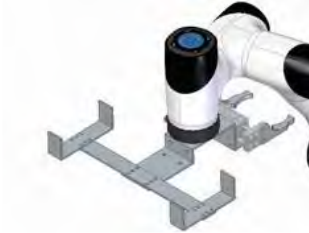
[그림 2-1224] 스마트팜 자동화를 위한 재배베드 및 포트 이중 작업용 그리퍼 설계, 로보게이트
