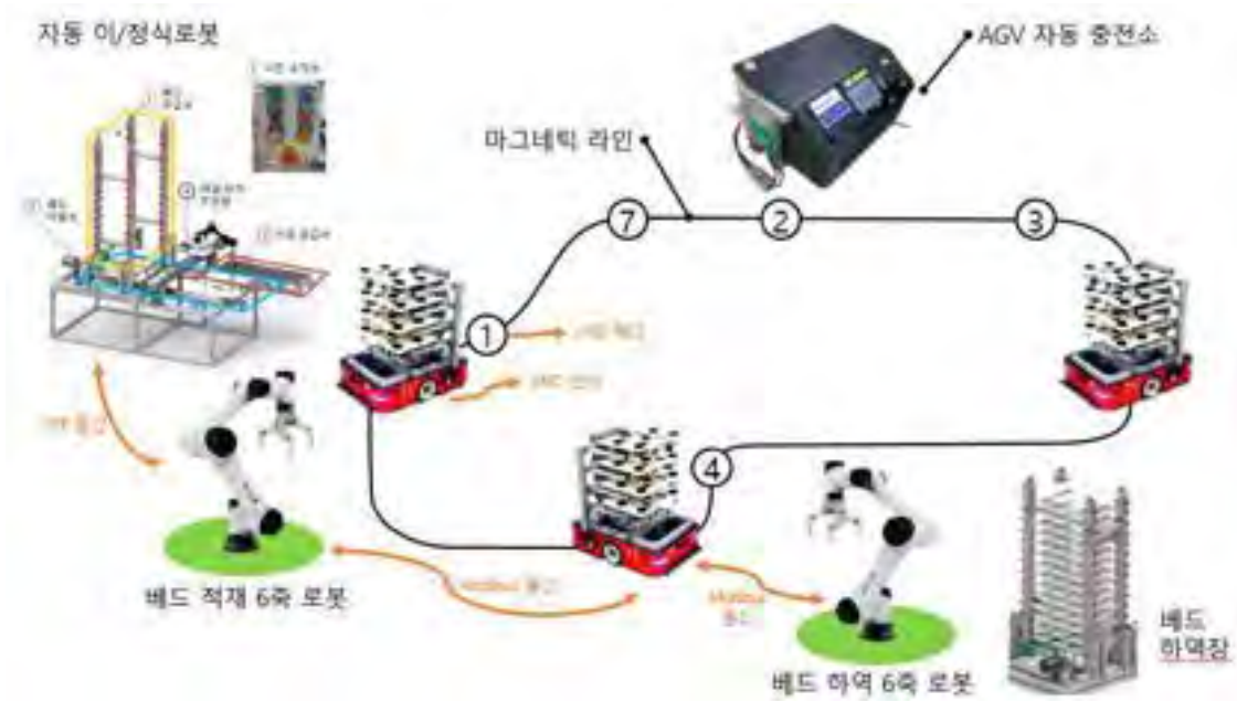
[그림 2-1261] 스마트팜 식물공장 테스트 베드 구축 시나리오 1 - 평판형 재배베드, 로보게이트
