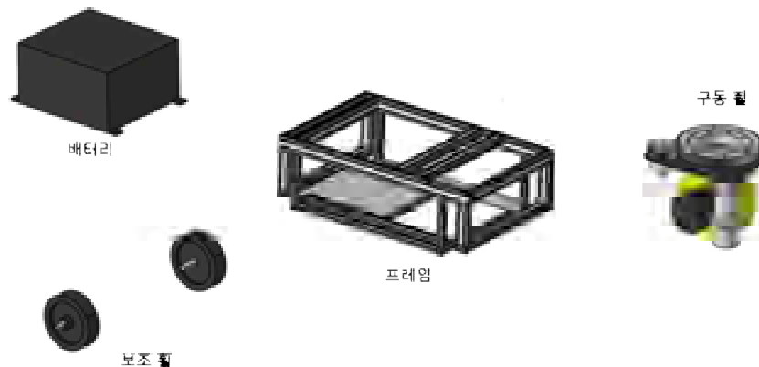
[그림 2-1186] 로보게이트의 스마트팜 전용 AGV 테스트 플랫폼 2차 시제품 해석 모델
