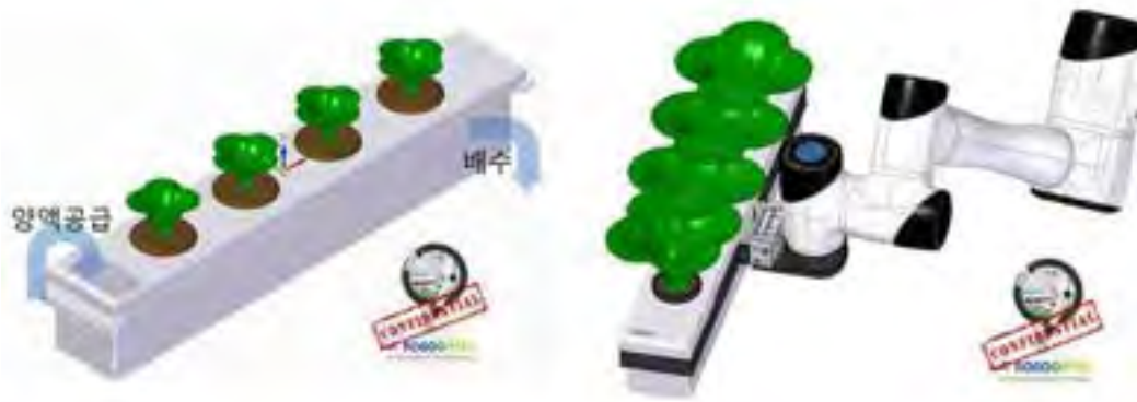
[그림 2-1223] 스마트팜 자동화 공정에 사용될 이동형 작물재배 베드 및 그리퍼 설계, 로보게이트
