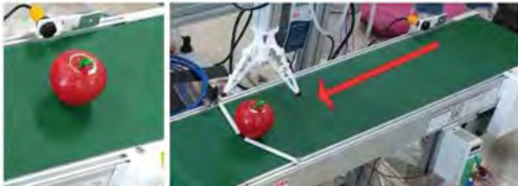
[그림 2-1272] 과일 자동 선별 포장 시스템 구현 테스트 모습, 로보게이트
