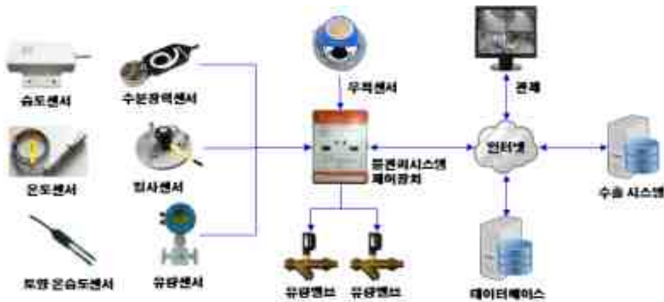
[그림 2-398] 물관리 모니터링 시스템 구조도
