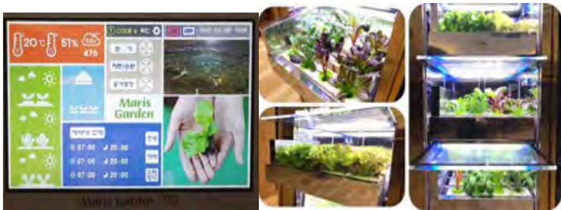
[그림 2-109] 공기정화기능을 구축한 간이재배기의 환경 제어, 터치형 모니터 및 서랍형 재배 베드
