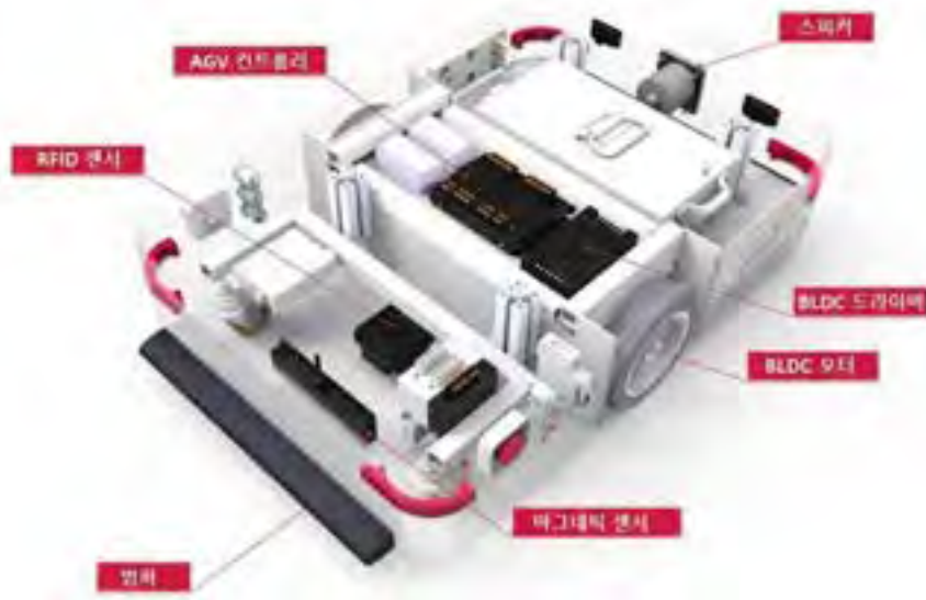
[그림 2-1237] 이정식 로봇 연계 스마트팜 AGV 내부구조, 로보게이트
