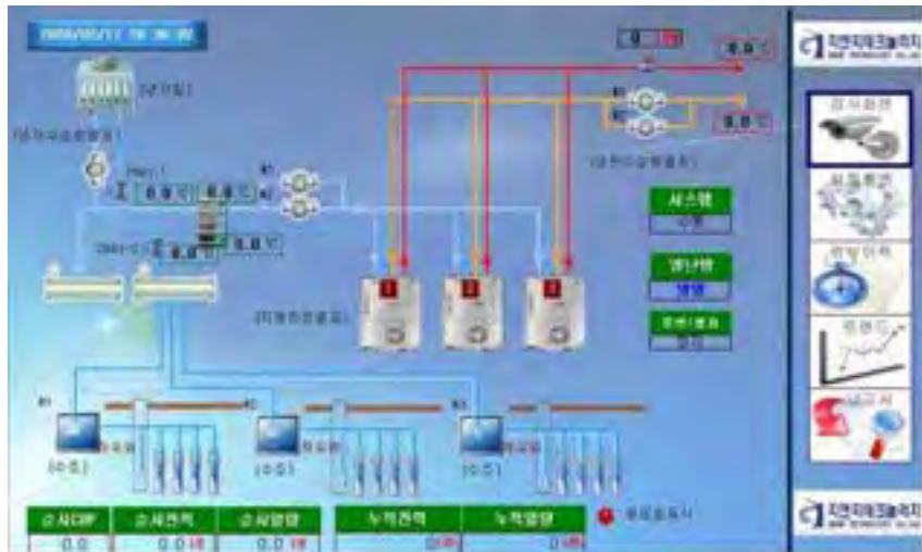
[그림 2-249] 스마트팜용 지열시스템(지오썸하이브리드) 자동제어 화면
