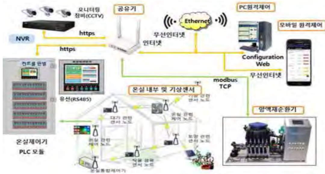
[그림 2-172] K-Plant 1.5세대 환경제어시스템
