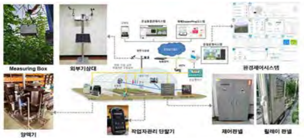
[그림 3-3] 스마트팜 현장설치 계측장비 및 운영시스템 개요도
