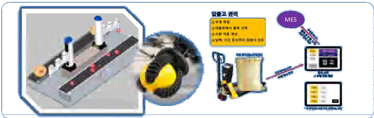
[그림 2-1228] 계량형 상품 자동 선별 포장 및 자동 입출고 시스템
