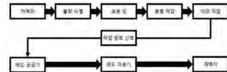
[그림 2-1119] 수경재배 자동화 라인의 공정 설계
