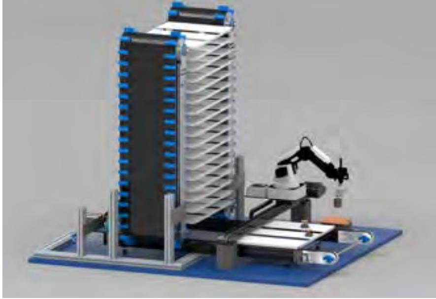
[그림 2-1153] 수경재배자동화 라인 전체 3D 설계1
