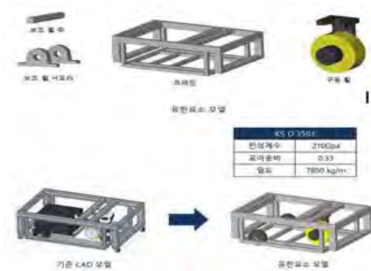
[그림 2-1194] 로보게이트의 스마트팜 전용 AGV 테스트 플랫폼 2차 시제품 유한요소해석 모델수정
