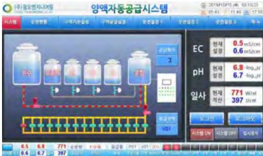
[그림 2-483] 양액 시스템 정보 전달 UI
