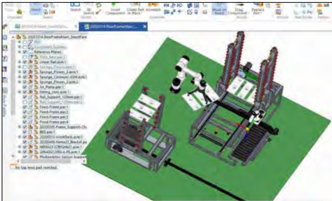
[그림 2-1262] 각 모듈간 연계 시스템 3D CAD 설계작업, 이정식 로봇과 자율주행 카트, 로보게이트
