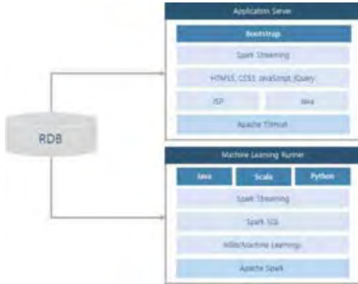
[그림 2-632] 모니터링 모듈의 시스템 아키텍처
