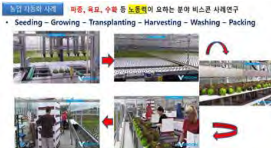
[그림 2-1092] Viscon의 수경재배 자동화 프로세스 공정 내용
