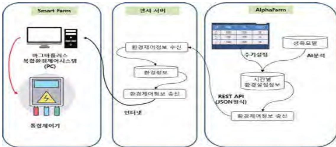
[그림 2-735] 환경 제어 시스템 구성도
