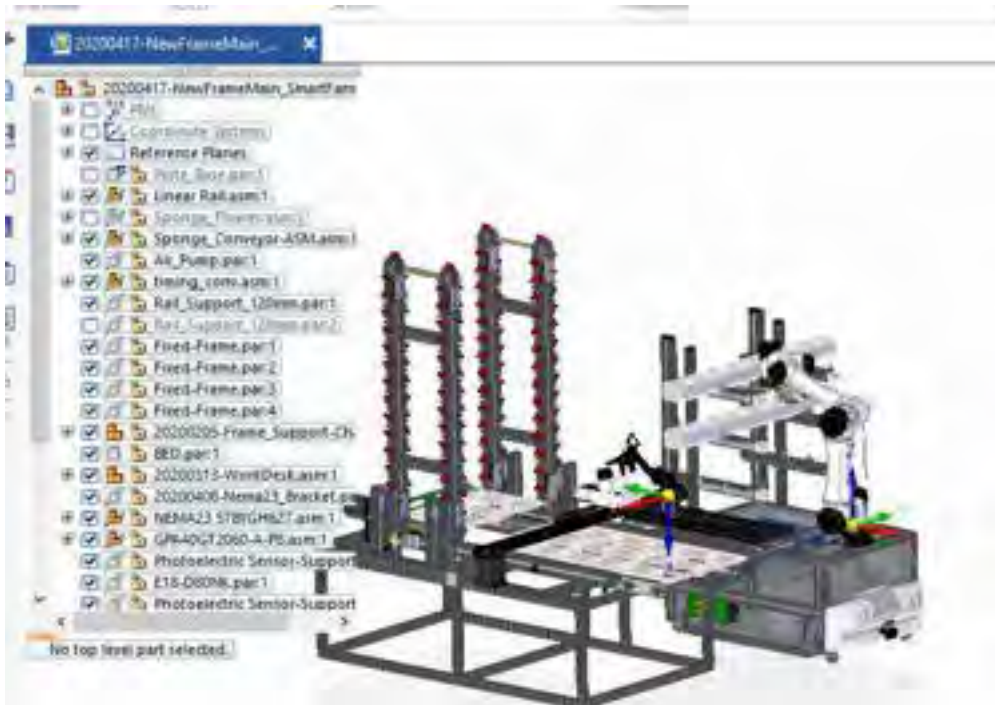
[그림 2-1243] 각 모듈간 연계 시스템 3D CAD 설계작업, 모바일 로봇과 이정식 로봇 2, 로보게이트
