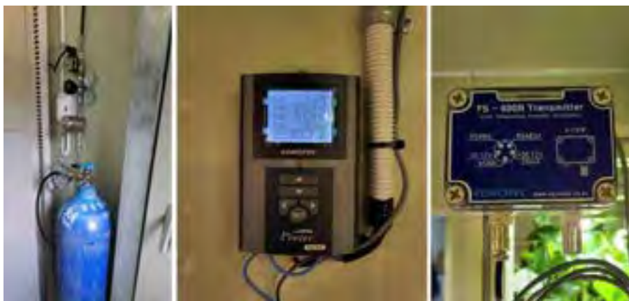
[그림 2-1054] 이산화탄소 공급장치 및 센서
