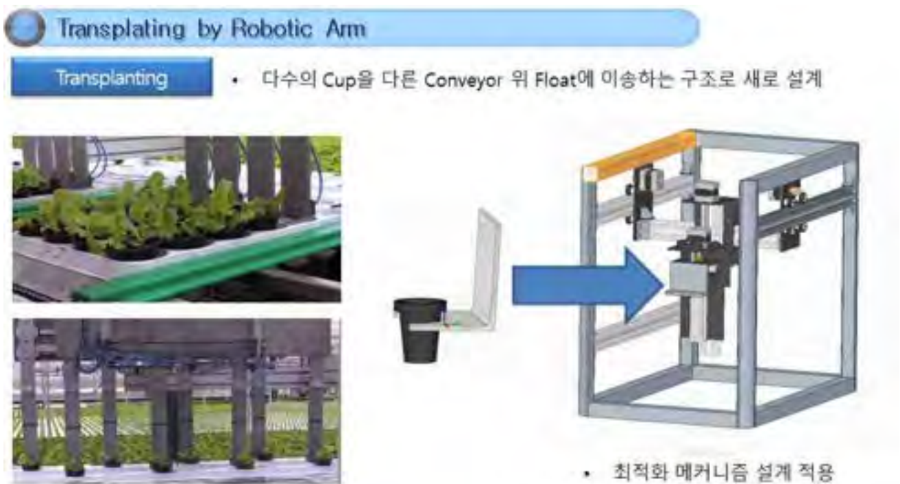
[그림 2-1114] 수경재배공정 자동화 전용 Transplanting Module 개발
