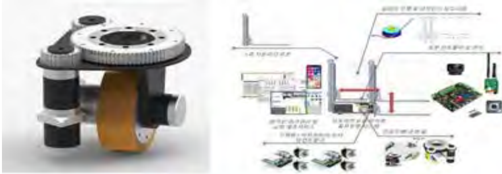
[그림 2-1198] 로보게이트의 스마트팜 전용 AGV 테스트 플랫폼 2차 시제품 구동-조향 일체형 휠 구조
