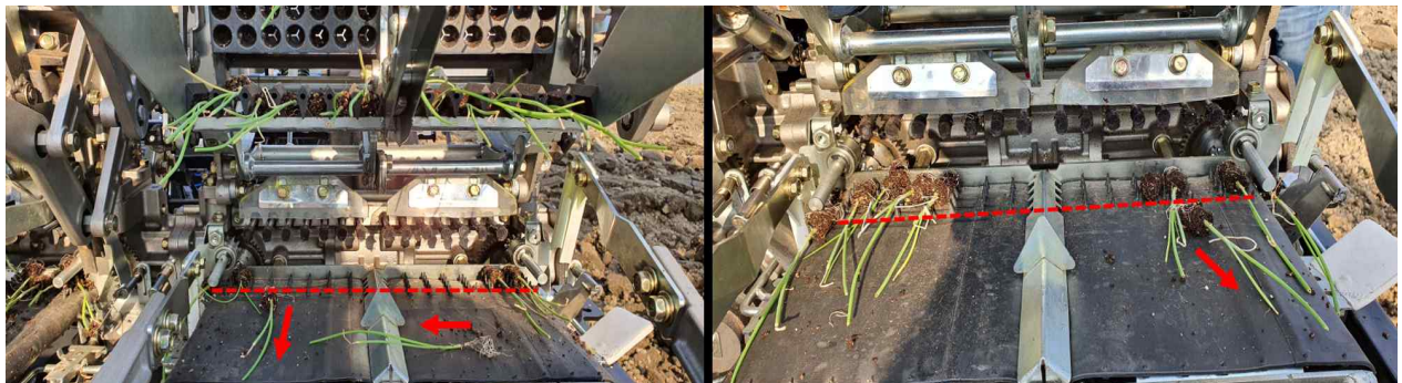
그림 215. 양파 모종은 높은 진동 노출로 인해 컨베이어 벨트의 트랙에서 갈라졌음. 점선은 트랙 위치를 나타내고 화살표는 분할 방향을 나타냄
