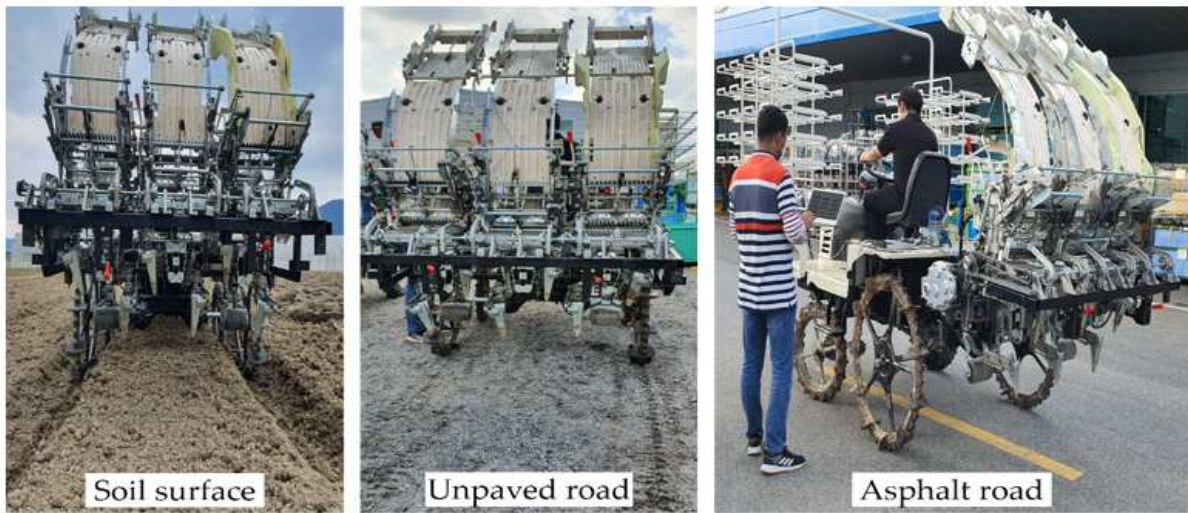
그림 211. 다양한 주행 표면 조건에서 진동 측정
