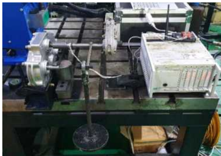
그림 166. 호퍼 구동축 토크 캘리브레이션 사진
