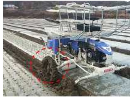
그림 13 습답에서 전복된 보행형 양파정식기 및 슬립이 발생하는 모습
