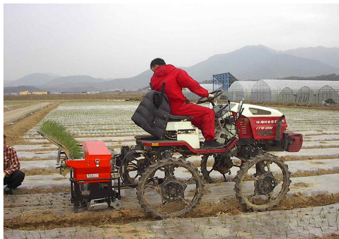
그림 12 승용관리기 부착형(경남농업기술원) 정식기와 반자동 정식기(농진청)
