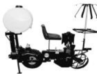
그림 63. 회전식 트레이 홀더가 부착된 반자동식 정식기
