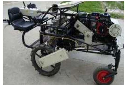
그림 12 승용관리기 부착형(경남농업기술원) 정식기와 반자동 정식기(농진청)
