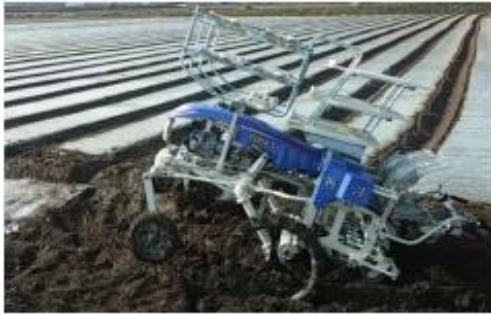
그림 13 습답에서 전복된 보행형 양파정식기 및 슬립이 발생하는 모습
