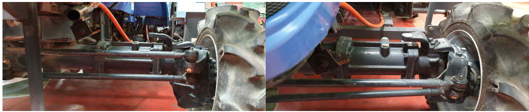
그림 80. 전차축 트랙로드 및 타이어 구조
