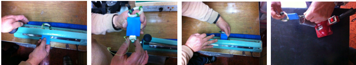
그림 9. 링타입 삼입형 바이오 온도센서의 방수처리 및 제작과정
