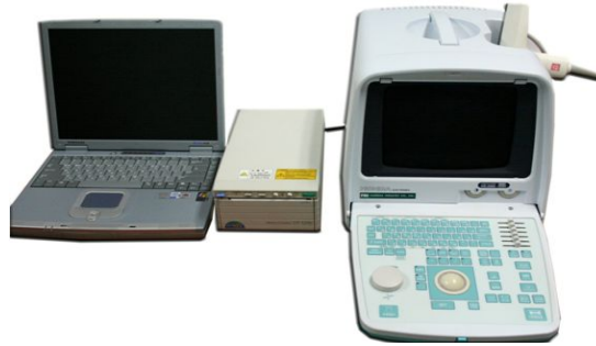
그림 5. Real-time Ultrasound(1.5-3MHz frequency: 180mm linear probe, HS-2000, FHK, Japan)
