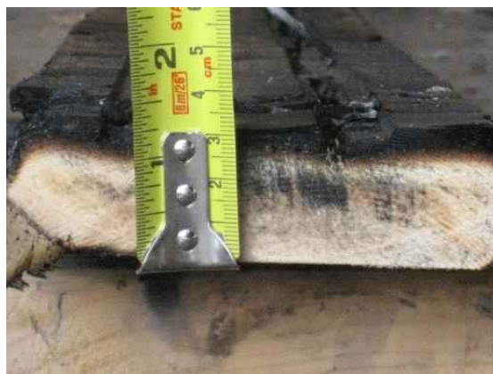
그림 B2-57. 비가열면의 목재 벽넬 그림 B2-58. 비가열면 목재 벽넬의 단면
