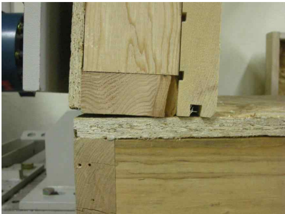
그림 B3-41 바닥-그린티ம்ப러월 패널 직각접합부에서 패널의 회전 변형
