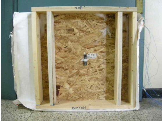
a) 실험 후 벽체 내부에 얼어있는 수분 b) 실험 후 단열재에 얼어있는 수분 그림 B1-68. EX-G-6-S 패널의 단열성능 시험 후 벽체 내부에 응결된 수분
