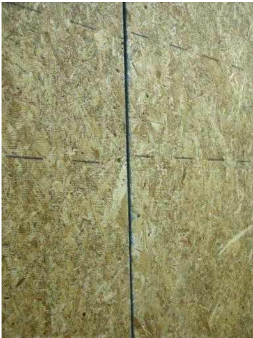
그림 B3-22 실제 수평하중저항 시험에서 덧개재료의 회전
