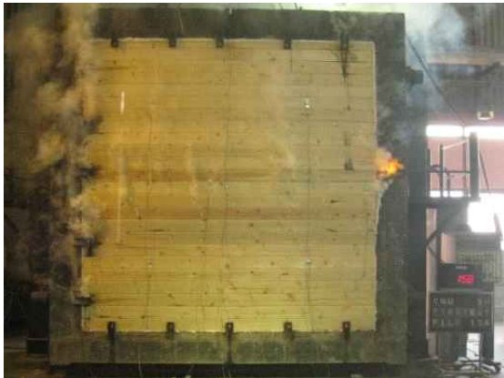
그림 B2-55. 비가열면에 화염 발생
