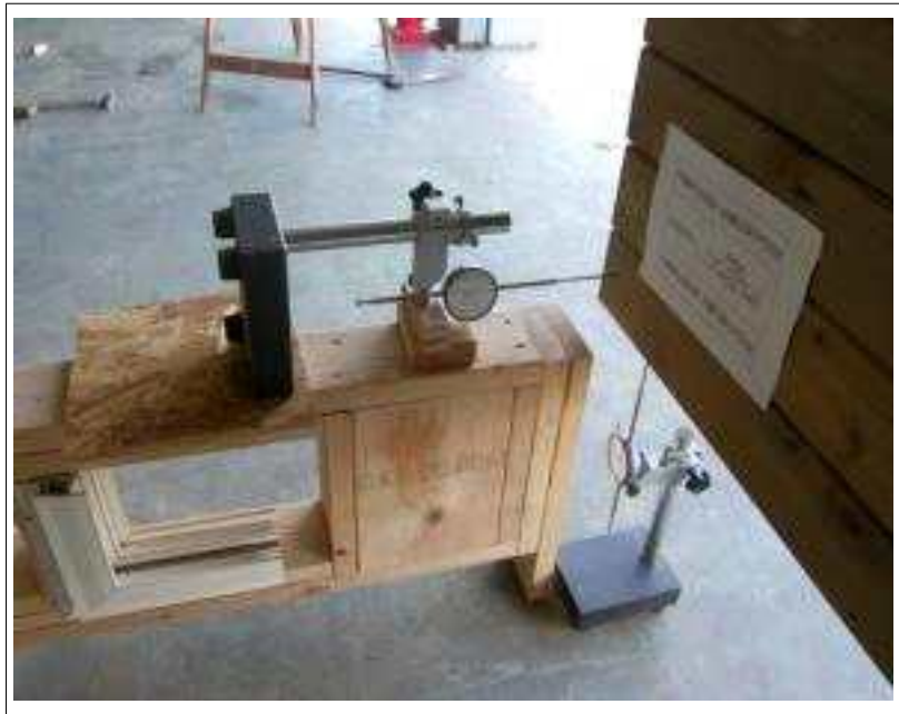
그림 A1-29. 그린티ம்ப러월 패널 시험편의 변형 측정을 위한 다이알게이지의 설치
