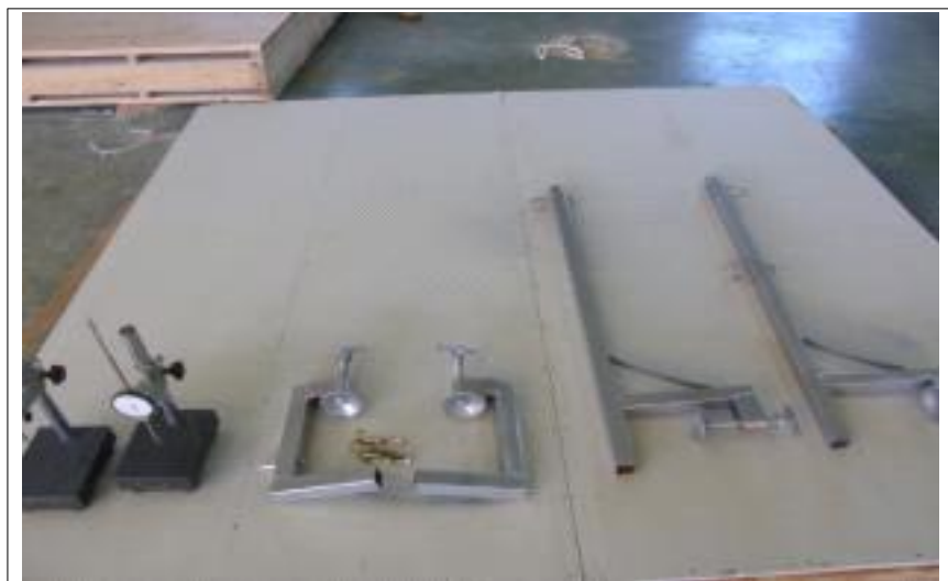
그림 A1-26. 변형 측정 시험에 사용된 시험편 고정철물 및 다이알게이지
