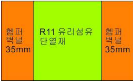
그림 B2-91. H-GH-4-GH 패널의 구성
