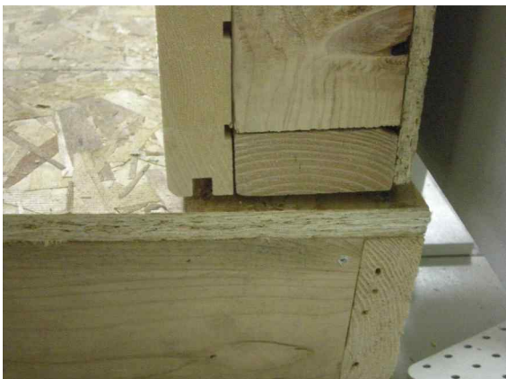
그림 B3-42 바닥-그린티ம்ப러월 직각접합부에서 패널의 들림 변형
