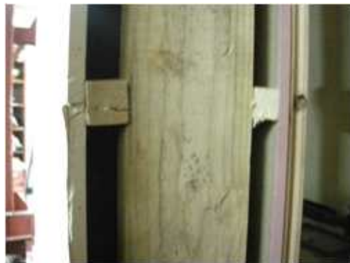
그림 B1-35. 내단열층이나 외단열층이 설치된 패널에서 버팀대의 갈라짐에 의한 파괴
