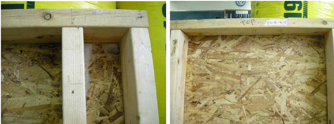
a) 실험 후 벽체내부에 얼어있는 수분 b) 실험 후 벽체 내부에 습기가 맺힌 모습
