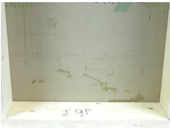
a) 실험 후 벽체 내부에 응결된 수분 b) 실험 후 단열재 내부에 응결된 수분 그림 B1-69. EX-GN-6-FX 패널의 단열성능 시험 후 벽체 내부에 응결된 수분
