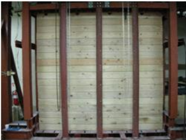
그림 B1-27. IN-G-4-G 패널의 수평하중저항시험
