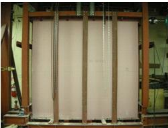
그림 B1-18. EX-GN-6-FX 패널의 수평하중저항시험
