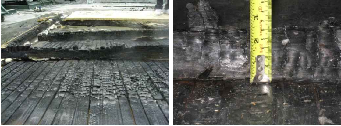
그림 B2-38. 비가열면 목재벽널 및 스테드 그림 B2-39. 남아있는 스테드의 깊이
