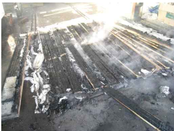
그림 B2-57. 비가열면의 목재 벽넬 그림 B2-58. 비가열면 목재 벽넬의 단면
