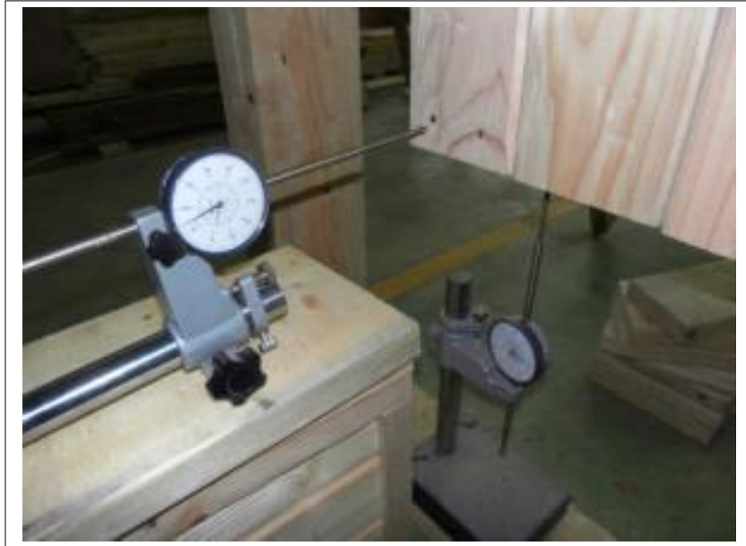
그림 A2-32. 그린팁버아트월 패널의 변형 측정을 위한 다이알게이지 설치
