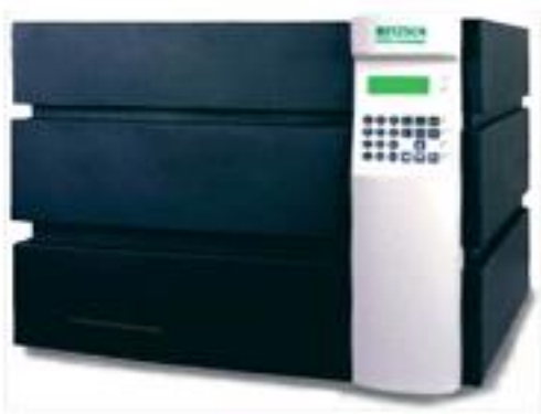
그림 B2-89. 평판 열류계식 단열계수 측정장비 그림 B2-90. 목재 시험편의 삽입
