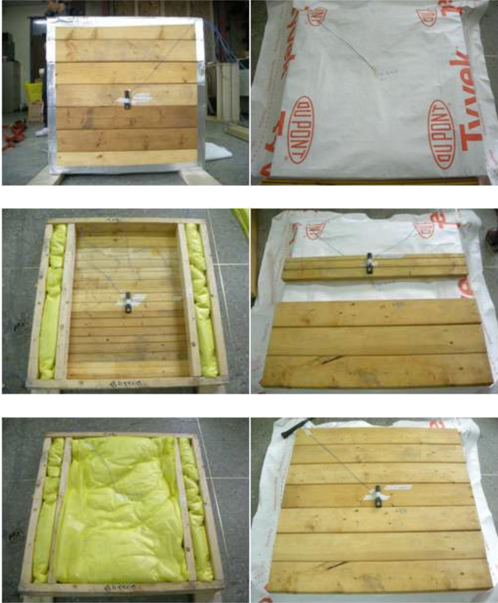
그림 B1-47. EX-G-4-P 패널에 대한 온도 및 습도센서의 부착
