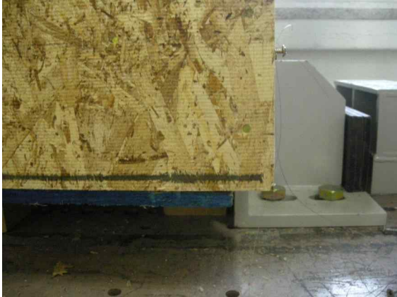
그림 B3-28 직각접합부에서 하중이 작용하는 반대쪽의 변형
