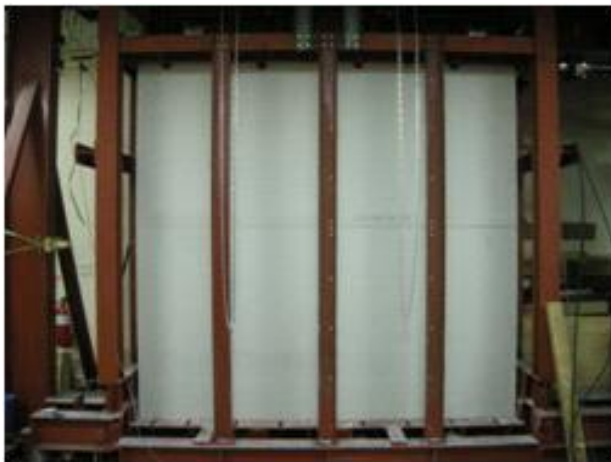
그림 B1-21. IN-B-4-B 패널의 수평하중저항시험
