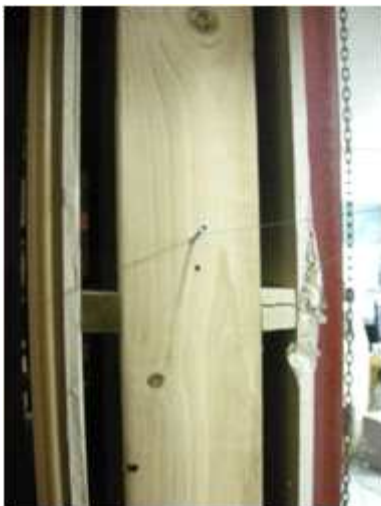
그림 B1-35. 내단열층이나 외단열층이 설치된 패널에서 버팀대의 갈라짐에 의한 파괴
