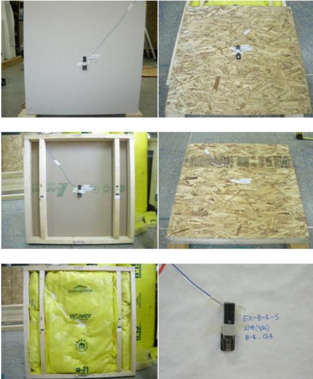
그림 B1-38. EX-B-4-S 패널에 대한 온도 및 습도센서의 부착
