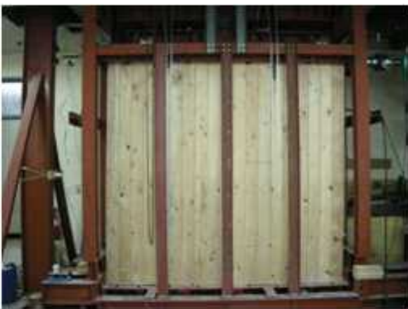
그림 B1-30. IN-GB-6-NG 패널의 수평하중저항시험
