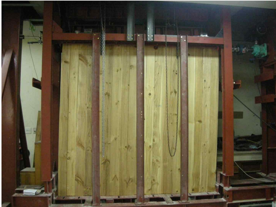
그림 B3-46 국산 잣나무 그린팁버릴 패널(N-GH-4-GV)에 대한 수평하중저항시험
