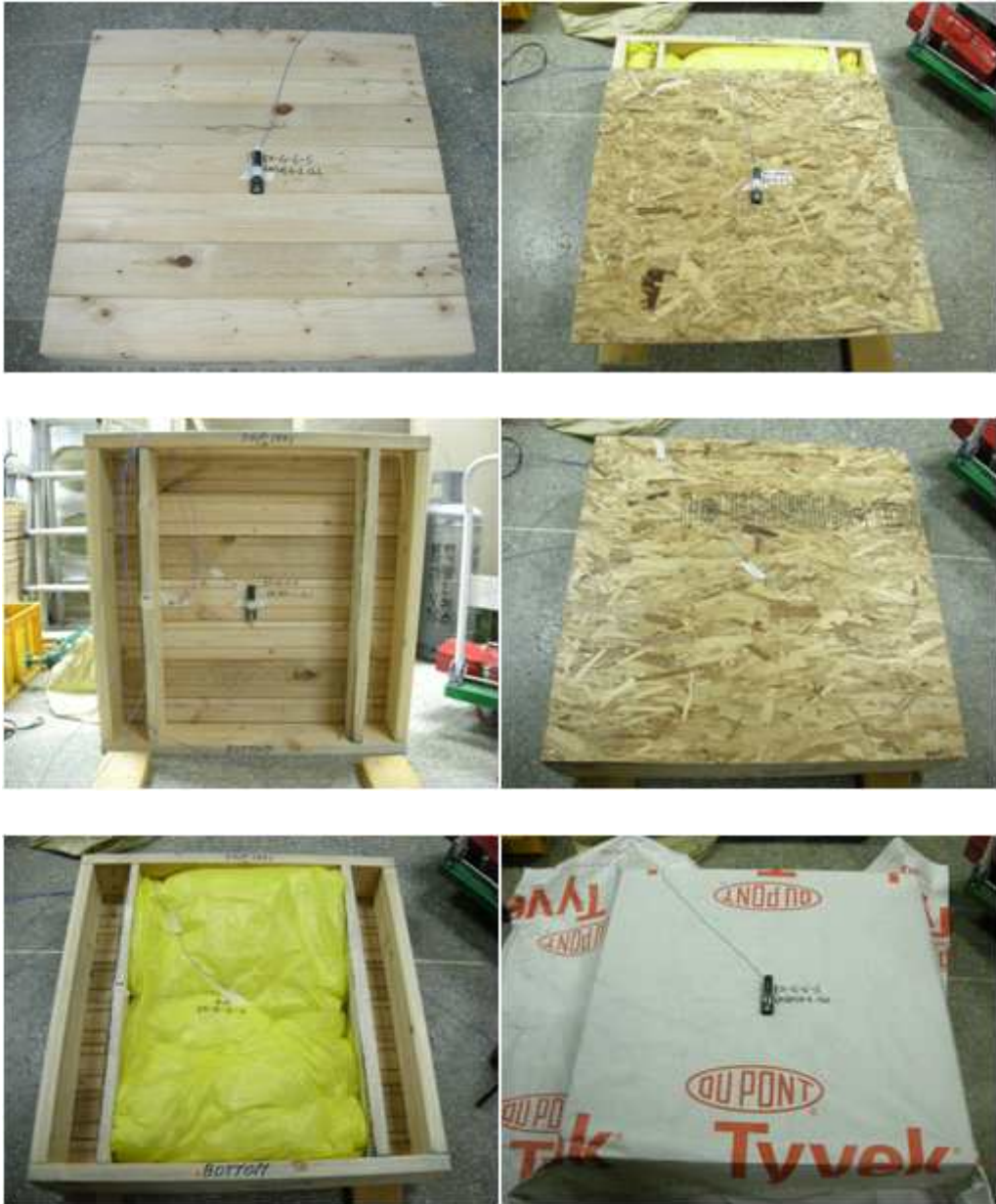
그림 B1-50. EX-G-6-S 패널에 대한 온도 및 습도센서의 부착
