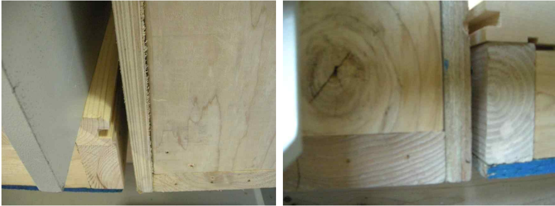
그림 B3-45 바닥-그린티머월 패널 직각접합부에서 패널의 들림(뽑힘) 변형
