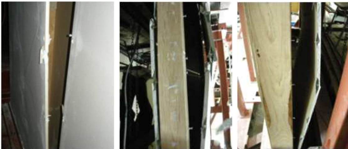
a) IN-B-6-B의 파괴 b) IN-B-4-B의 파괴 c) EX-B-6-S의 파괴
