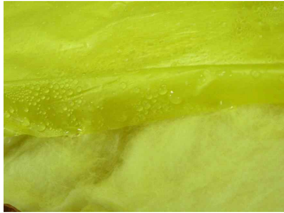
a) 실험 후 벽체 내부에 얼어있는 수분 b) 실험 후 단열재에 응결된 수분
