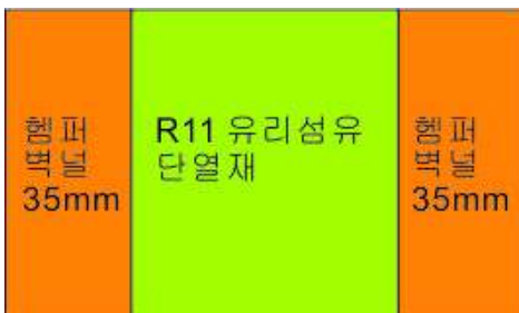
그림 B3-58 H-GH-4-GH 패널의 구성
