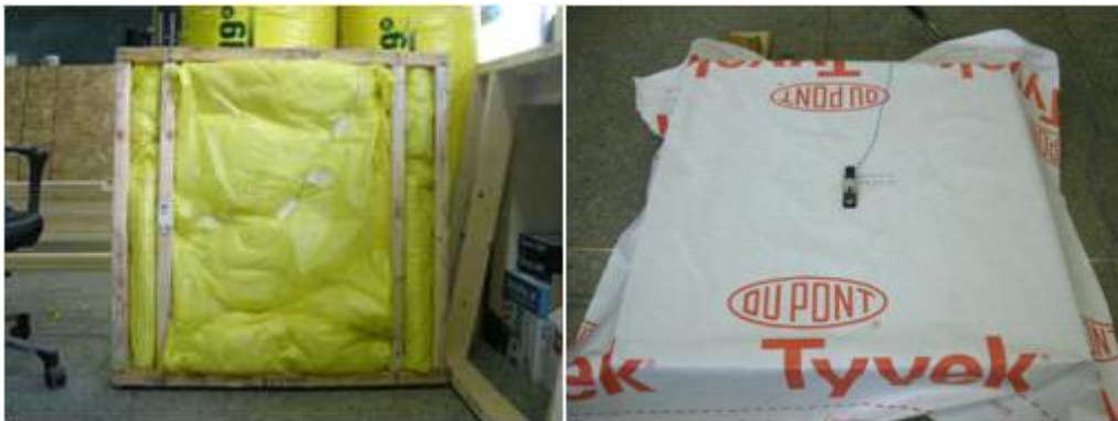
그림 B1-44. EX-G-4-S 패널에 대한 온도 및 습도센서의 부착
