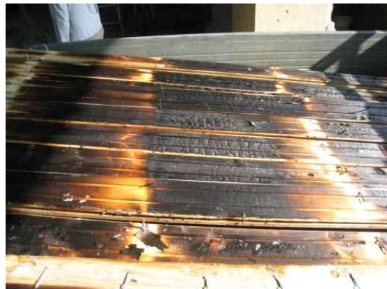
그림 A3-10 120분 가열 후 비가열면 목재 벽널의 안쪽
