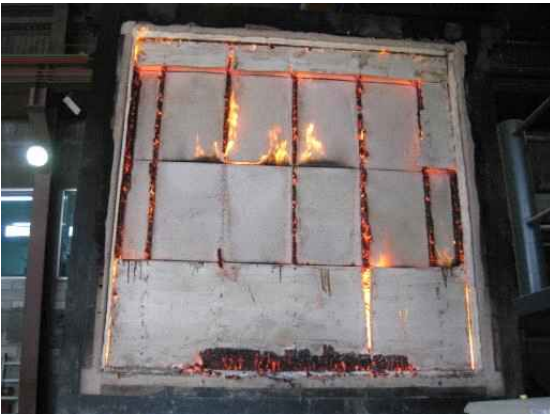
그림 A3-9 120분 가열 후 시험체 가열면
