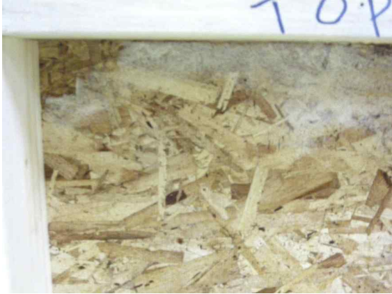
a) 실험 후 벽체 내부에 얼어있는 수분 b) 실험 후 단열재에 응결된 수분
