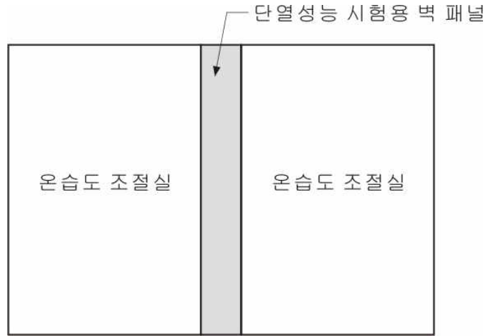
그림 B2-6. 그린팀버월 패널의 단열성능 시험방법
