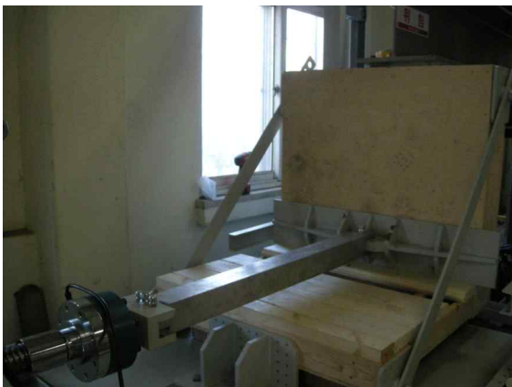
그림 B3-44 바닥-그린티ம்ப러월 패널 직각접합부에 대한 못뽑기(인발)저항 시험
