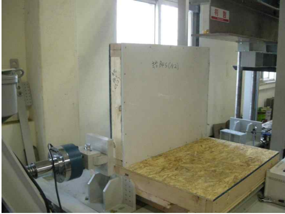
그림 B3-35 바닥-그린티이버월 패널 직각접합부에 대한 수평전단시험
