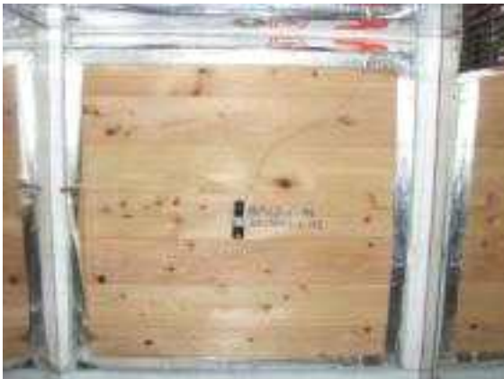
a) 단열성능 시험기에 시험편 설치
