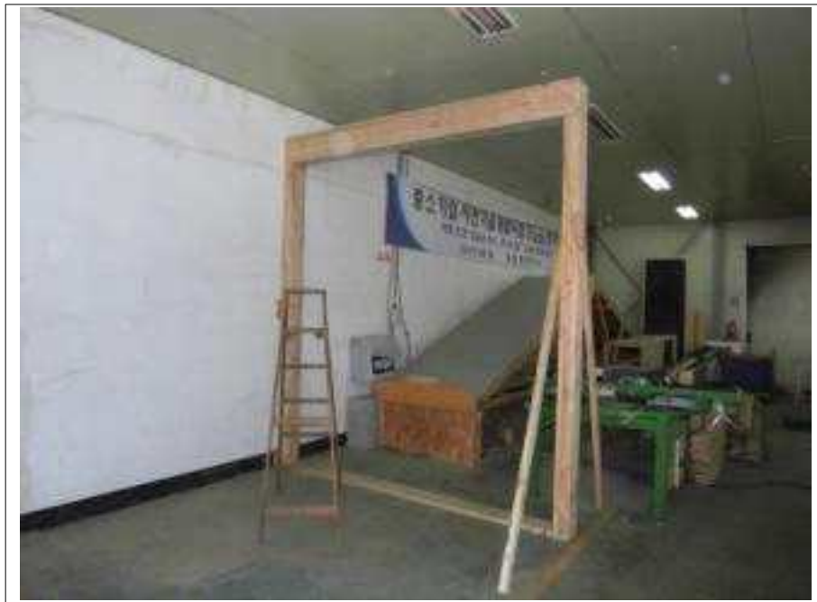
그림 A2-29. 변형 측정 시험에 사용된 시험편 고정틀
