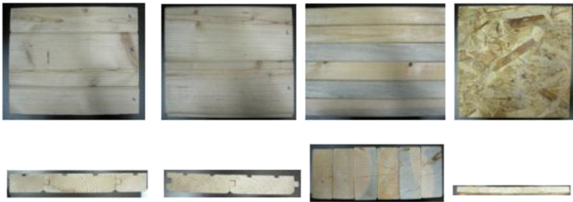
(a) 낙엽송 T&G벽널 (b) 험퍼 T&G벽널 (c) SPF 스테드 (d) OSB 덮개
