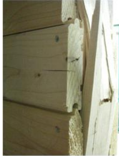
a) 스테드의 좌굴과 목재 벽널판의 전단변형 b) 스테드의 좌굴에 의한 파괴
