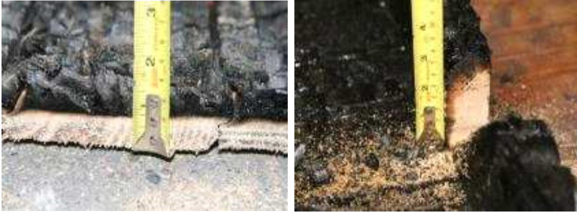
그림 B2-52. 비가열면 목재벽넛 및 스테드 그림 B2-53. 남아있는 스테드의 깊이
