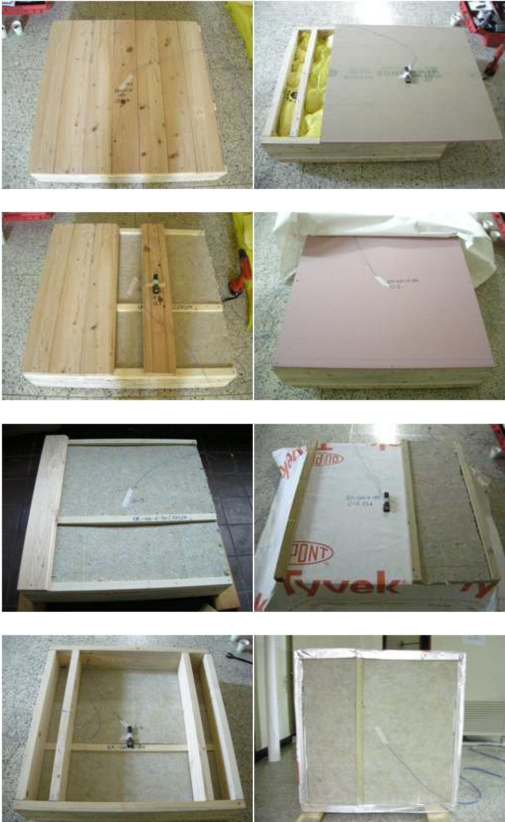
그림 B1-53. EX-GN-6-FX 패널에 대한 온도 및 습도센서의 부착
