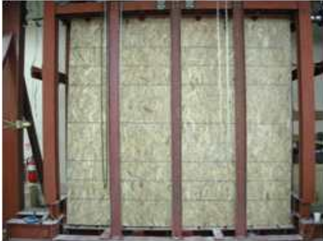
그림 B1-12. 패널 EX-B-4-S의 수평하중저항시험
