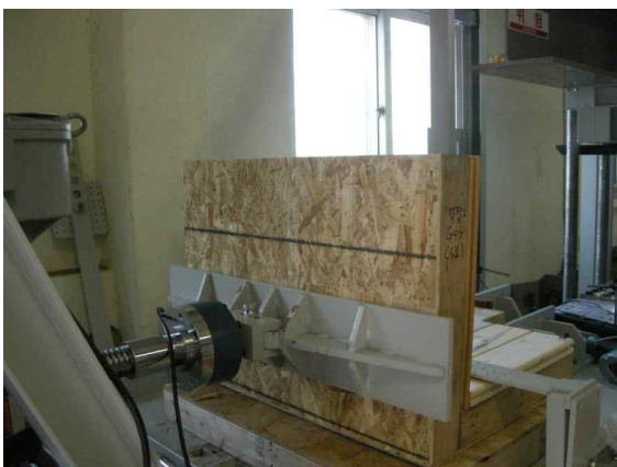
그림 B3-30 그린티이버월 패널 사이의 직각접합부에 대한 수직전단시험
