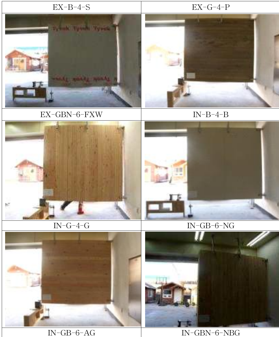
그림 A1-30. 그린팁버울 패널 시험편의 변형 측정
