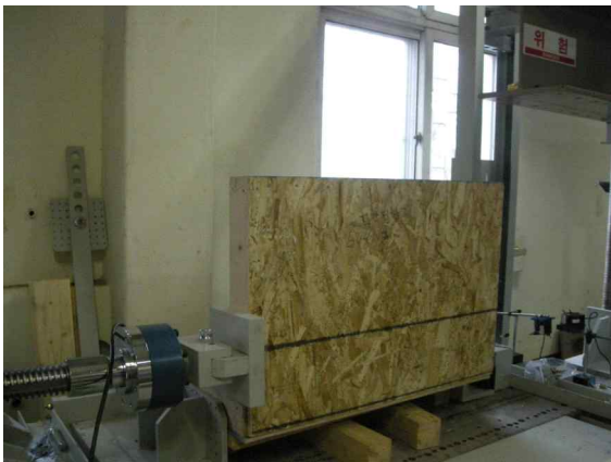
그림 B3-26 그린티ம்ப러월 패널 사이의 직각접합부에 대한 수평전단시험
