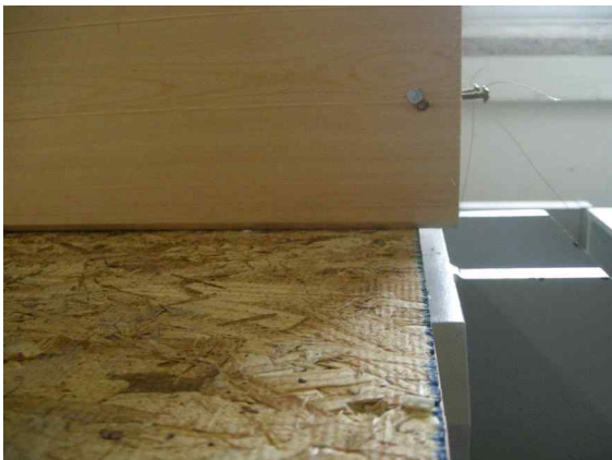
그림 B3-37 바닥-그린티이버월 직각접합부에서 하중이 작용하는 반대쪽의 변형
