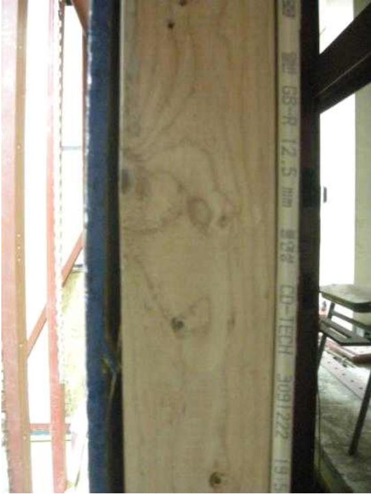
그림 B3-23 수평하중 하에서 덮개재료의 회전에 따른 못의 뽑힘
