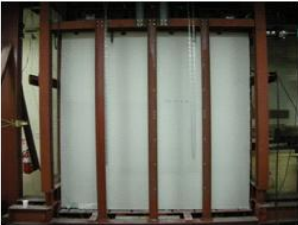
그림 B1-24. IN-B-6-B 패널의 수평하중저항시험
