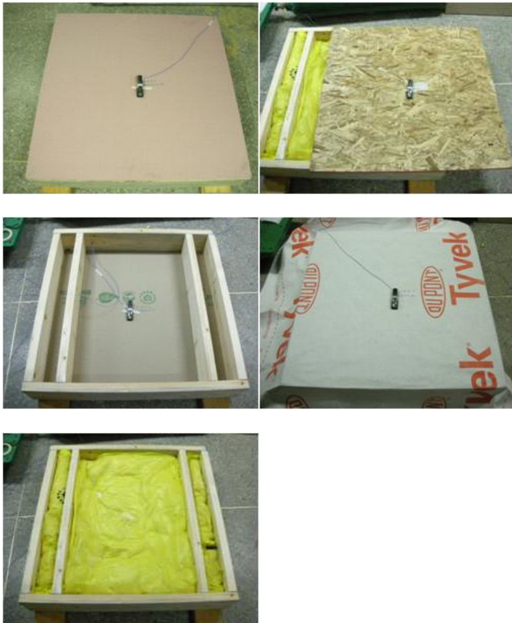
그림 B1-41. EX-B-6-S 패널에 대한 온도 및 습도센서의 부착
