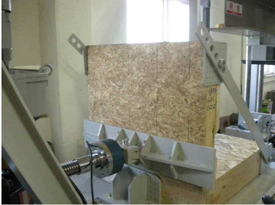
그림 B3-40 바닥-그린티ம்ப러월 패널 직각접합부에 대한 수직전단시험
