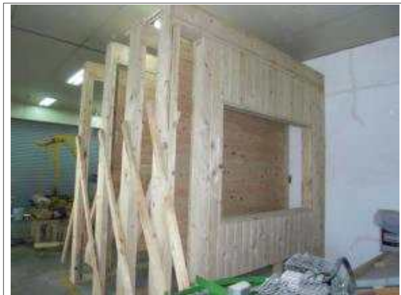
그림 A2-31. 시험편 고정틀에 변형 측정용 벽체 시험편 설치 모습
