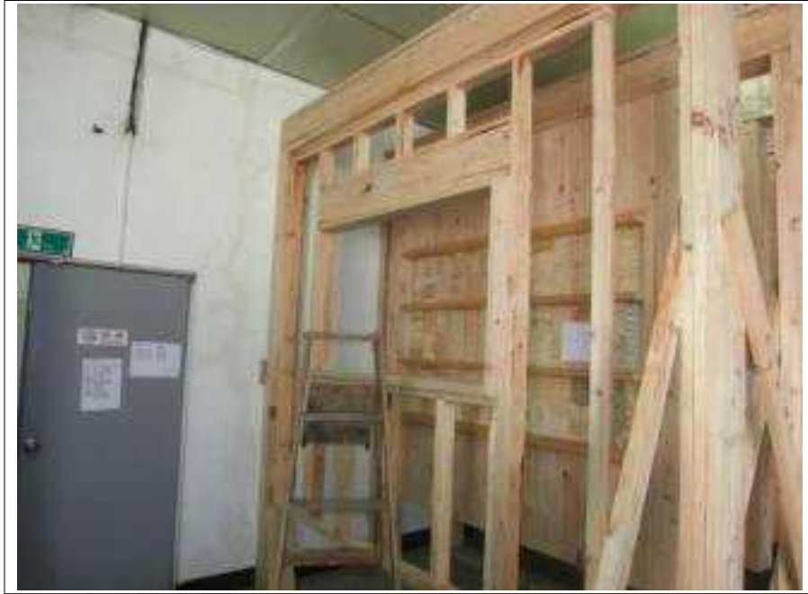
그림 A2-30. 시험편의 세 모서리를 못접합으로 고정
