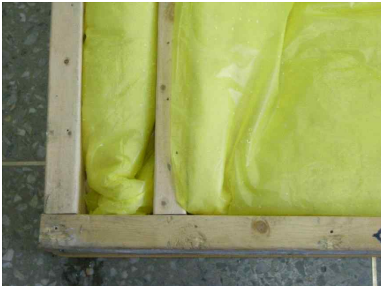
a) 실험 후 단열재에 응결된 수분 b) 실험 후 목재벽널 내부에 응결된 수분
