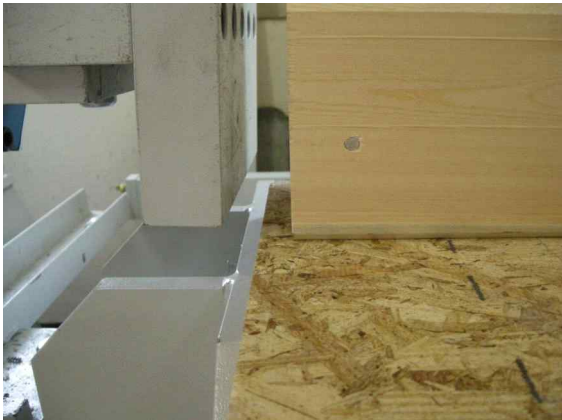
그림 B3-36 바닥-그린티이버월 패널 직각접합부에서 하중이 작용하는 쪽의 변형
