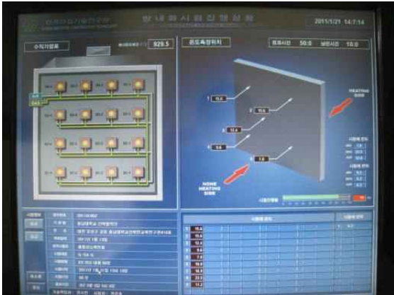
그림 B2-43. 시험체 비가열면의 표면 온도 그림 B2-44. 내화시험 종료 후 파괴된 가열면의 모습
