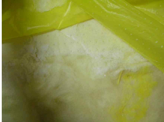
a) 실험 후 벽체 내부에 얼어있는 수분 b) 실험 후 단열재에 얼어있는 수분 그림 B1-68. EX-G-6-S 패널의 단열성능 시험 후 벽체 내부에 응결된 수분
