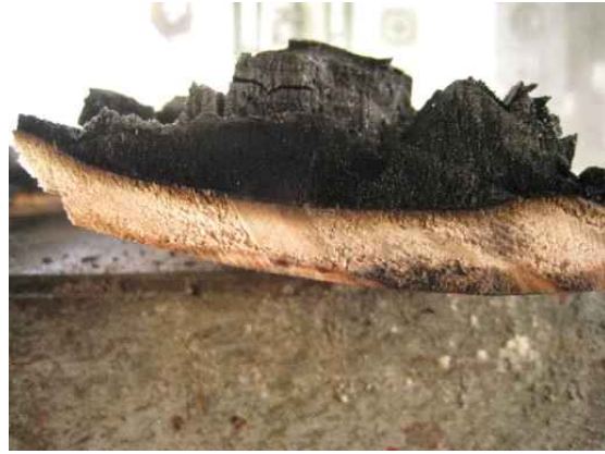
그림 B2-62. 비가열면의 목재 벽널 그림 B2-63. 비가열면 목재 벽널의 단면
