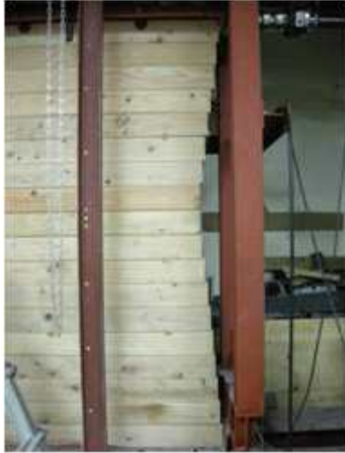
a) 스테드의 좌굴과 목재 벽널판의 전단변형 b) 스테드의 좌굴에 의한 파괴
