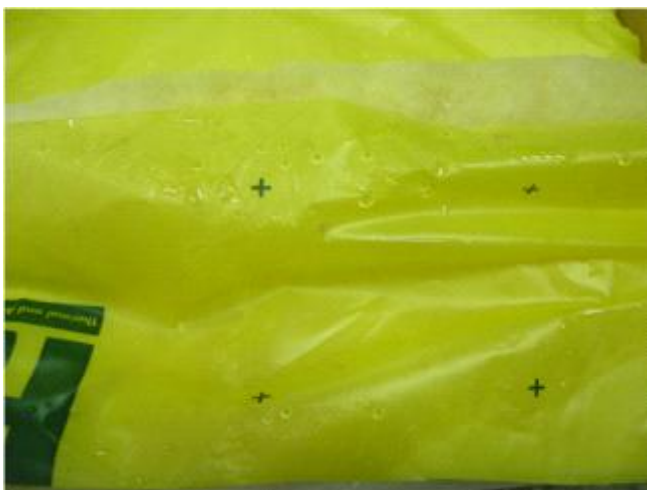
그림 B2-96. H-GH-4-GH(방수지 +비닐 설치) 패널 내부의 결로
