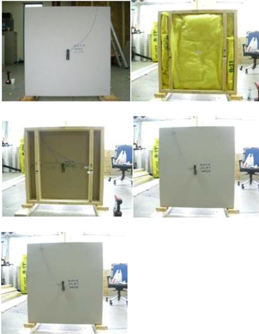
그림 B1-56. IN-B-4-B 패널에 대한 온도 및 습도센서의 부착
