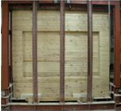
그림 B2-24. L-GH-4AW01-4-GH 패널의 벽체 강도시험 장치
