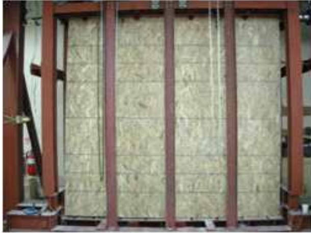
그림 B1-15. EX-B-6-S 패널의 수평하중저항시험
