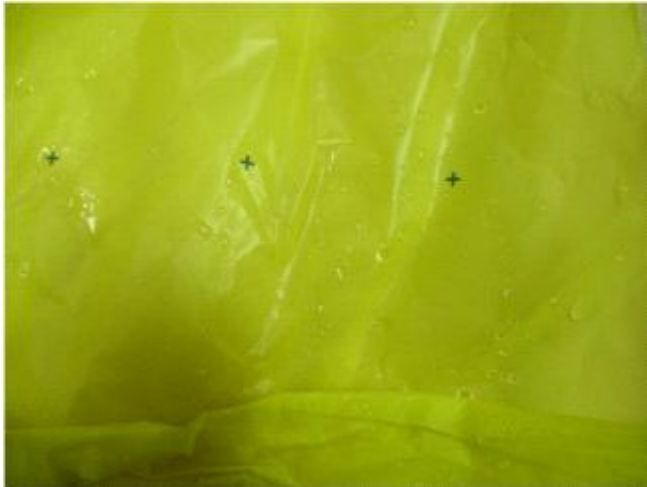
그림 B2-95. H-GH-4-GH(양면에 방수지 설치) 패널 내부의 결로
