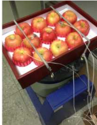
그림 3-144. 전자식 진동시험기를 이용한 사과 포장화물의 진동 및 충격시험
