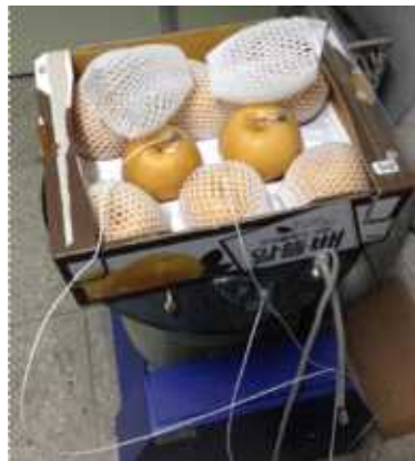
그림 3-145. 전자식 진동시험기를 이용한 배 포장화물의 진동 및 충격시험 1
