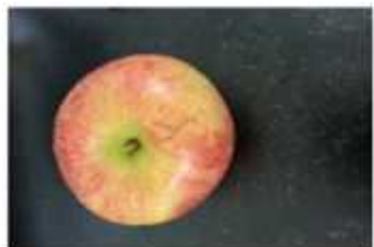
1,000mm 낙하 후 파손(터짐)
