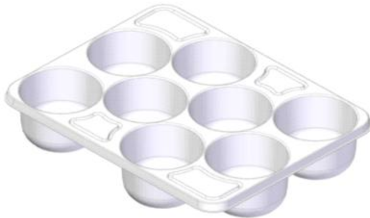
그림 3-66. 손잡이 홈이 가공된 8과 전용 택배용 난좌 3D 설계
