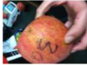
1,300mm 낙하 후 파손(터짐)
