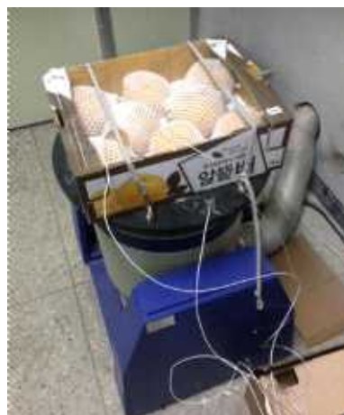
그림 3-146. 전자식 진동시험기를 이용한 배 포장화물의 진동 및 충격시험 2
