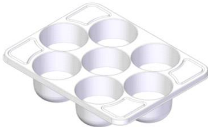
그림 3-62 손잡이 홈이 가공된 7과 전용 택배용 난좌 3D 설계
