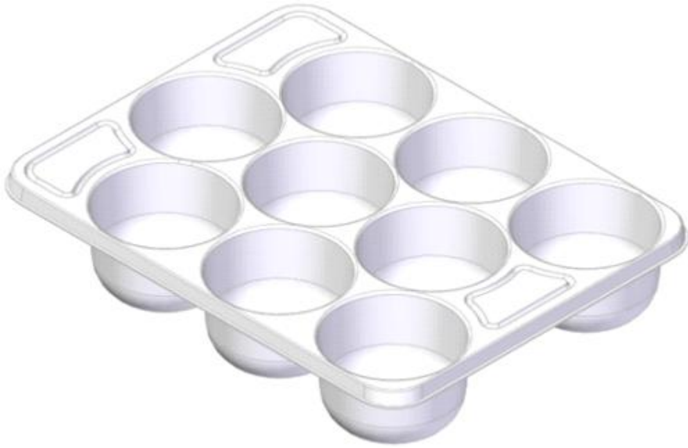
그림 3-72. 손잡이 홈이 가공된 9과 전용 택배용 난좌 3D 설계
