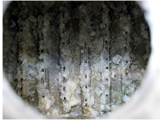
그림 87. 알루미늄 FCU의 지하수 부식 문제 발생
