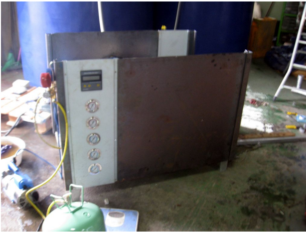
(a) 히트펌프 전면
