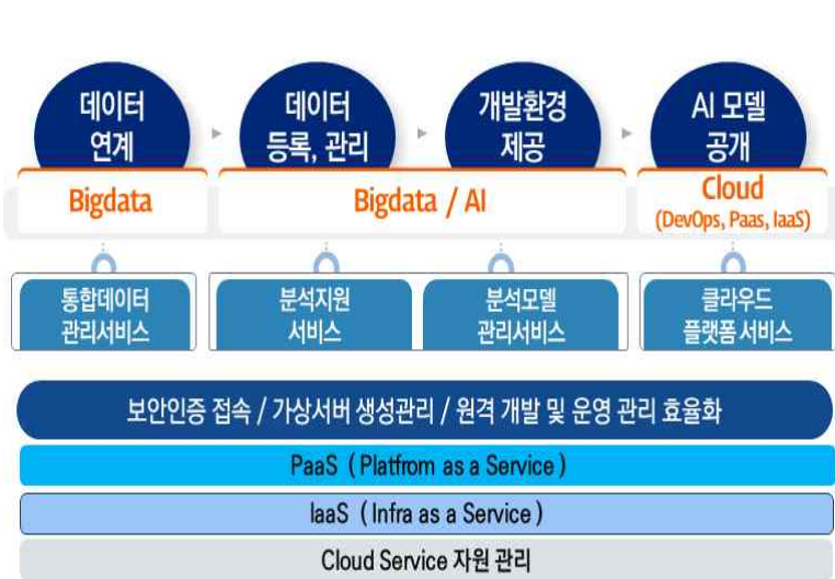
[그림 122] 분석지원 및 관리 가능한 수행 파이프라인
