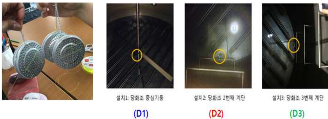
Figure 5-5. 파머스맥주 제조 시설 중 5t 당화조에 데이터 로거를 설치한 모습
