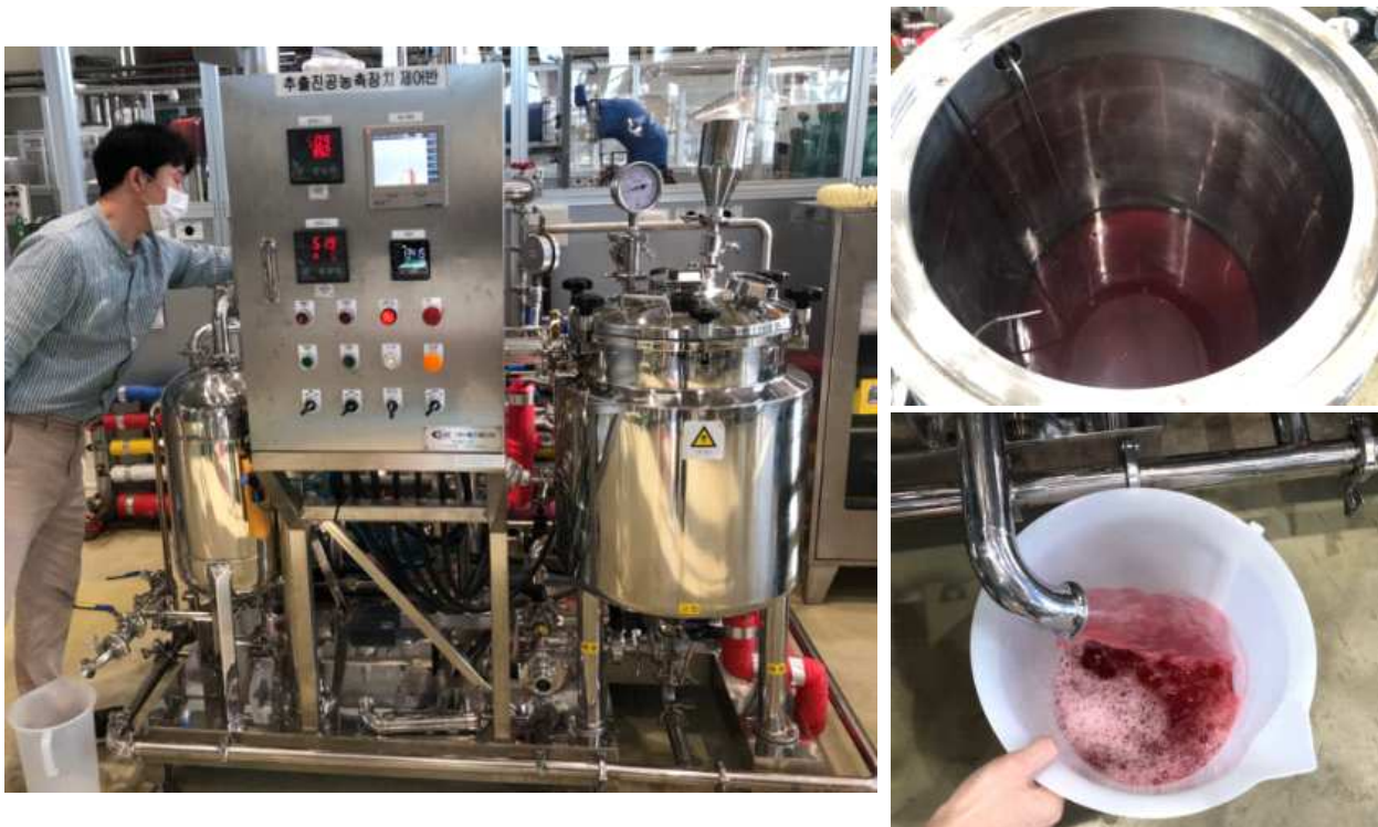
그림 3-4-20. 진공증류를 이용한 무알콜 레드와인 대량 제조 (좌: 진공증류 장치, 우상; 증류전 와인, 우하: 진공 증류후 무알콜 레드와인)
