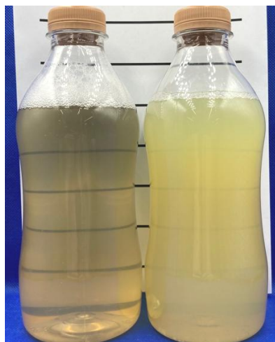
그림 66. 한외여과 및 정용여과 적용 유청단백질 용액의 정상 (좌)정용여과 유청단백질, (우) 한외여과 유청단백질
