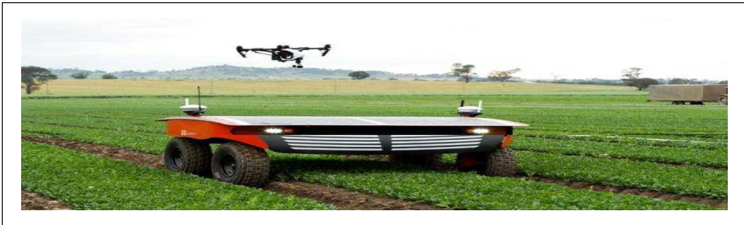
그림 3-16 호주 시드니 대학의 태양광 정밀 제초기
