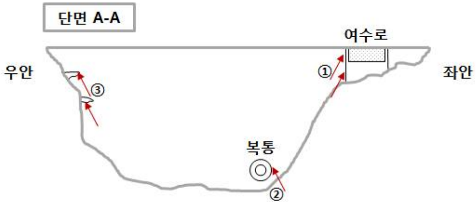
<그림 2-34> 댐의 내부침식(파이핑) 취약부(A-A단면도)
