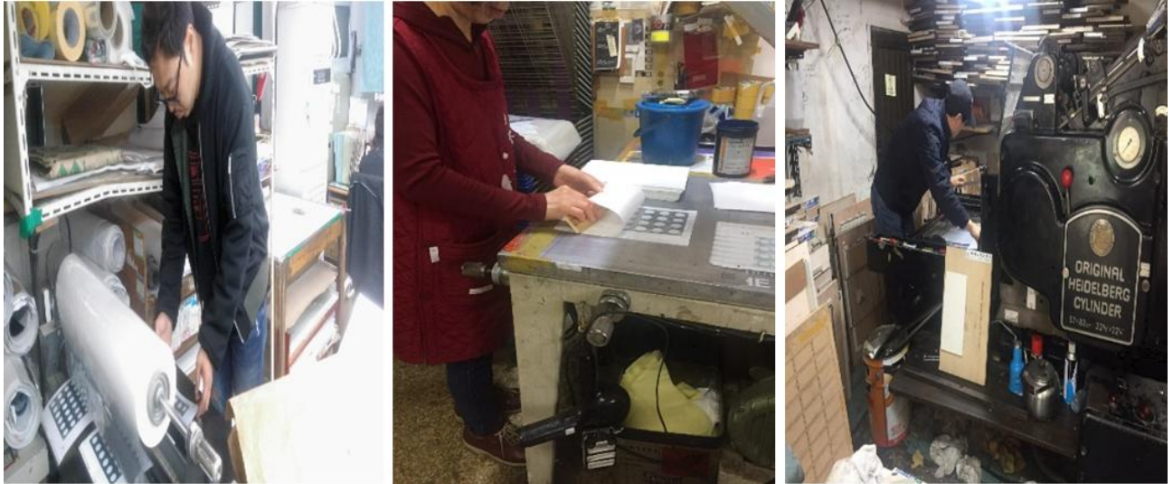
그림 2. 인쇄형 TTI 코팅, 접착부 부착 및 커팅 공정 사진
