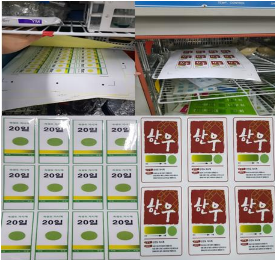
그림 35. 인쇄형 TTI 재현 품질평가 색변화
