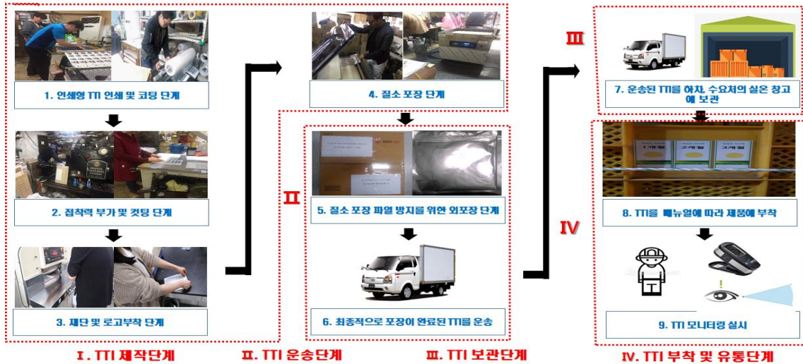
그림 31. 인쇄형 TTI 적용을 위한 현장 flow chart [TTI 제작 및 부착 유통단계] ((주)보성키위유통영농조합법인)
