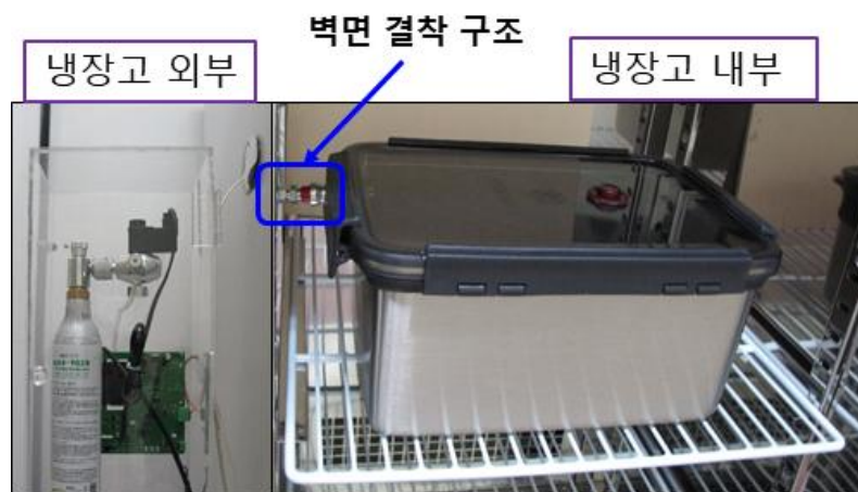
그림 7. 냉장고에 장착된 김치용기 시스템의 전체적 구조
