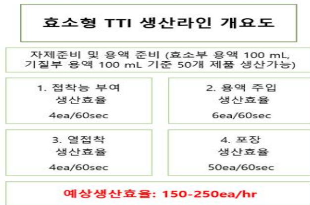
그림 77. 효소형 TTI 생산라인 개요도
