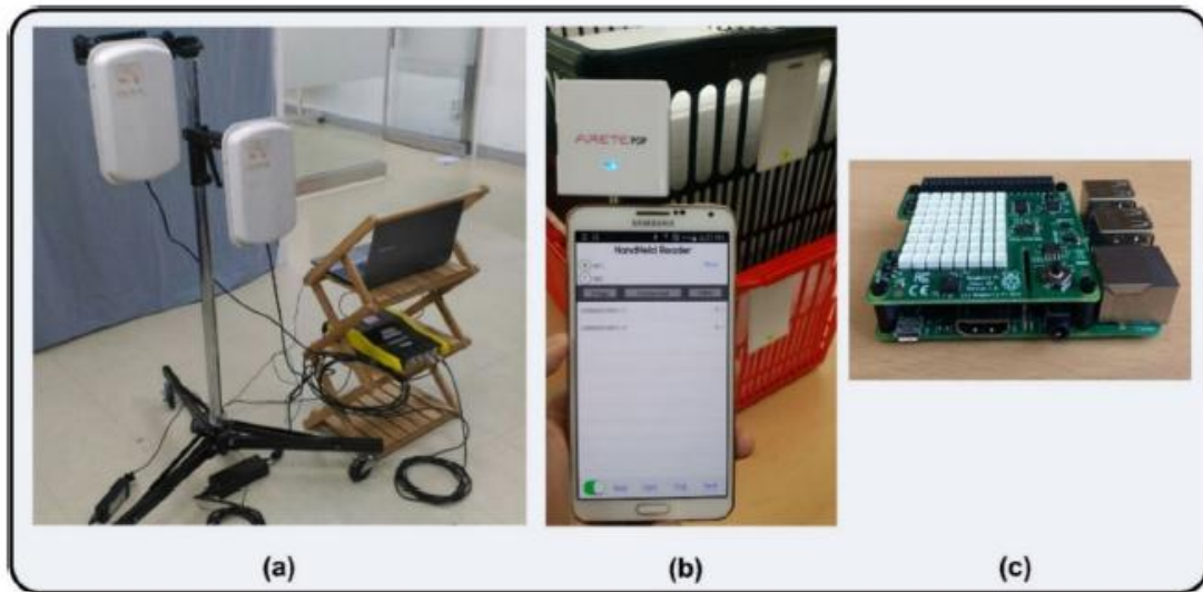
그림 59. 시스템 구현: (a) 고정 판독기, (b) 휴대용 판독기 및 (c) IoT 기반 센서
