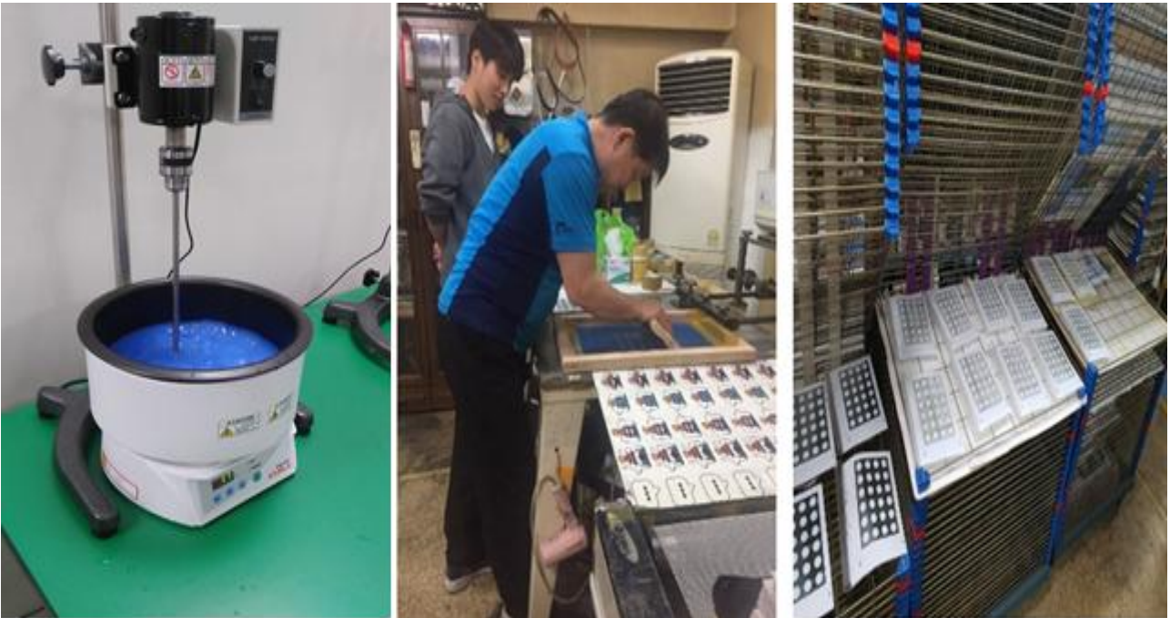
그림 1. 인쇄형 TTI 잉크 제조, 인쇄 및 건조 공정 사진
