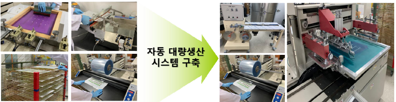
그림 66. 생산공정을 고려한 인쇄형 TTI 자동 대량생산 시스템
