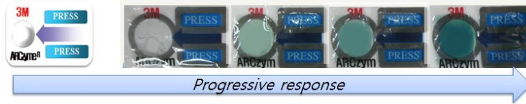
그림 2. ARCzyme® TTI 시제품 및 색 변화
