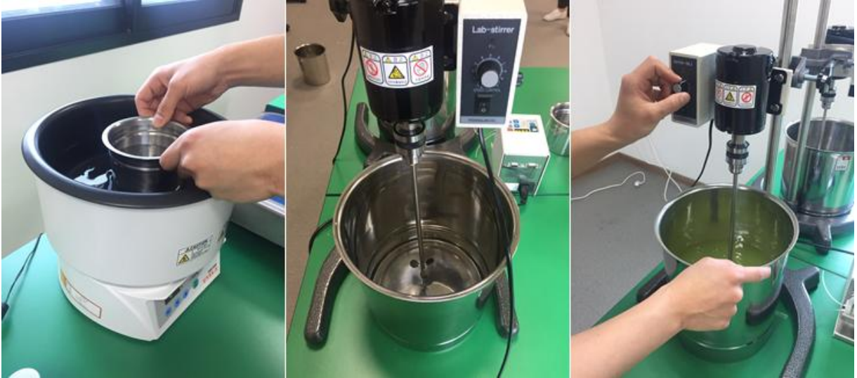
그림 7. 물질부 제조 Line (원료 칭량 및 배합 공정)
