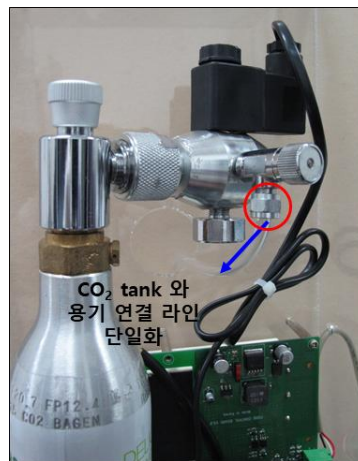
그림 6. 단일화 라인 연결부 형태(진공펌프 미 장착)
