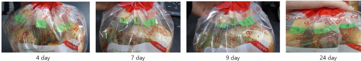
그림 56. 유연성 포장 내 부착된 2차 제작 지시계의 색 변화(좌측부터 1번, 2번, 3번, 4번 지시계)
