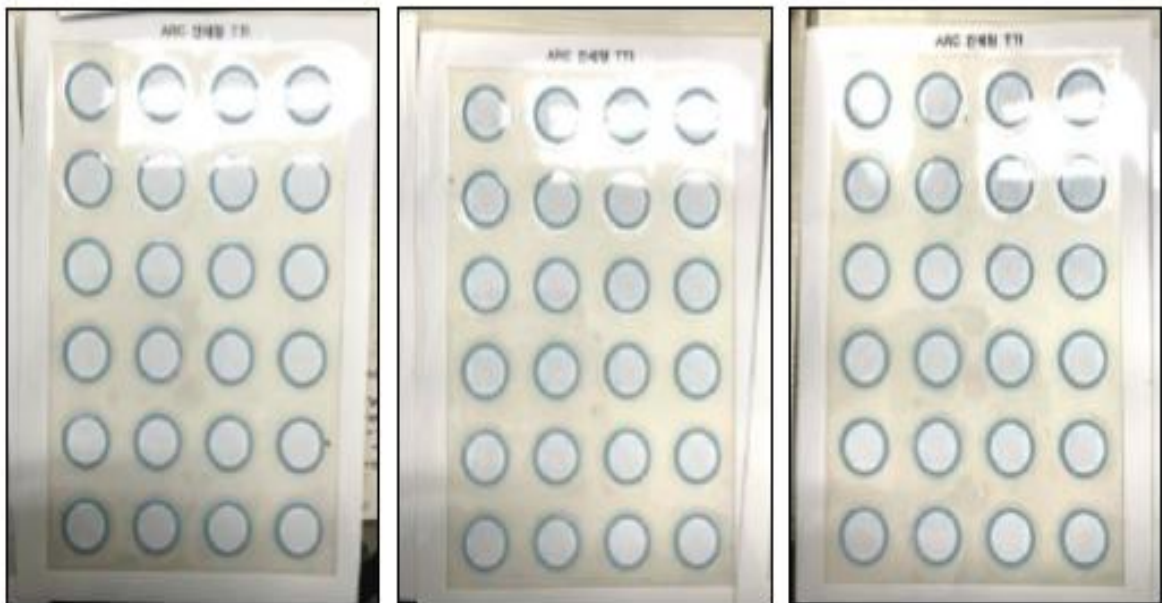
그림 28. 개봉(산소노출) 직후, 산소감지 필름 : 연한 하늘색 육안 확인
