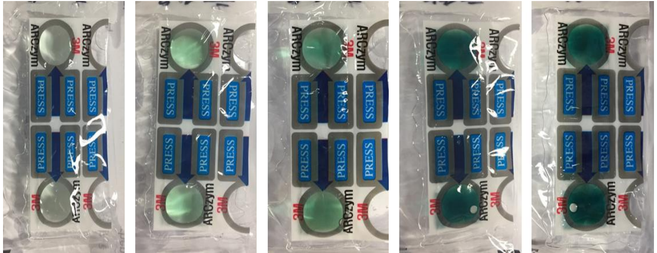
그림 25. 일정 농도로 제작된 효소형 TTI의 0°C에서 5일 간의 반응 결과
