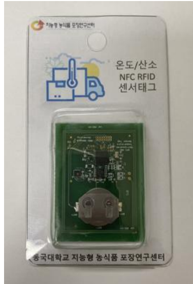
그림 74. 제작한 산소, 온도, 습도 센서와 결합된 NFC RFID 태그 시제품 사진
