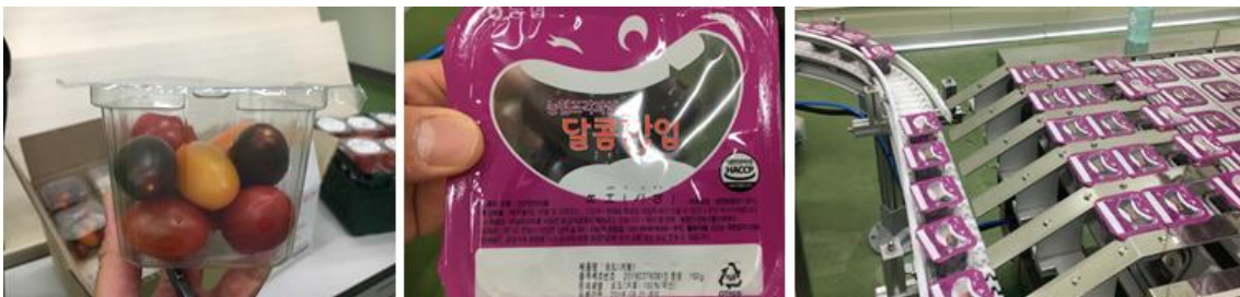
그림 4. 기능성 항균 조각과일 용기 및 탑씰링 항균필름
