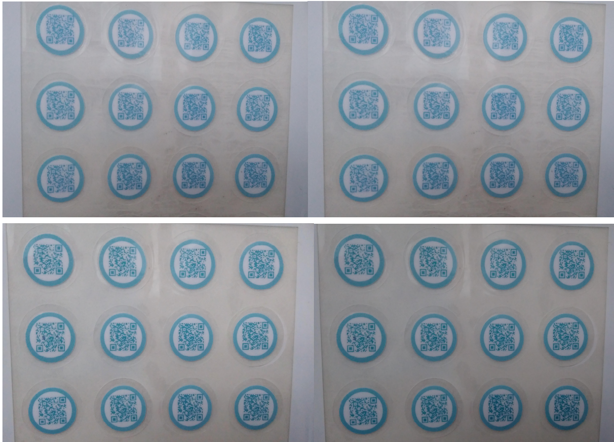
그림 13. 인쇄형 TTI(열코팅형)의 재현성 Test 결과(왼쪽 위부터 시계방향, 5, 10, 15, 25°C)
