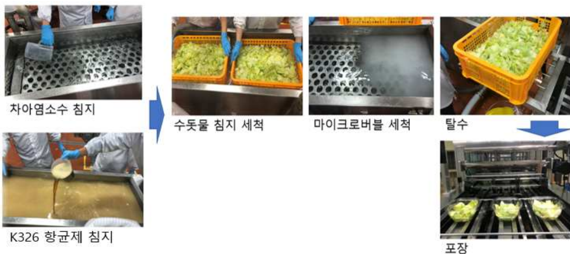
Fig. 3-3. 양상추의 차아염소수 및 K326 항균제 침지와 마이크로버블 세척 과정
