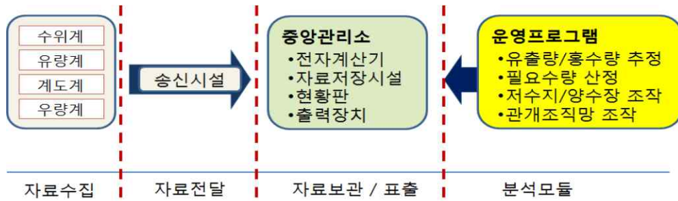
<그림 2-3> 물관리 자동화시스템 구성
