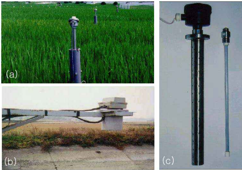
<그림 2-84> 담수심 측정기 (a. 압력식, b. 초음파식, c. 정전용량식)
