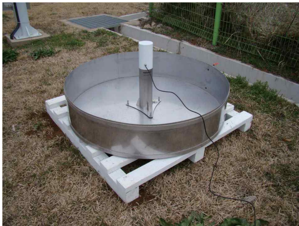
<그림 2-76> 대형증발팬에 장착 된 부력식 수위계
