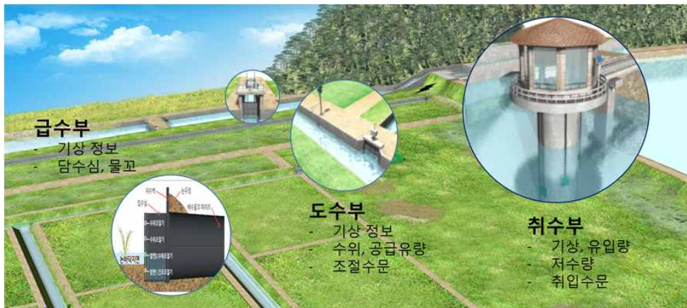
<그림 2-85> IoT 스마트 수리시설 인벤토리 구성
