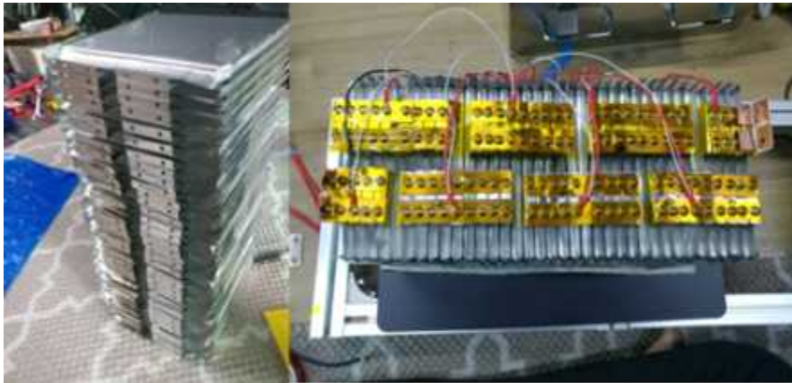
<그림> (좌)리튬폴리머 팩 (우)리튬폴리머 패키징
