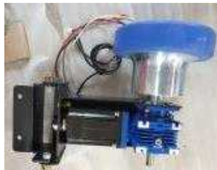
<그림> 구동 바퀴 조립
