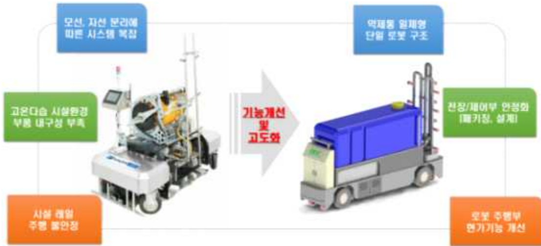
<그림> 시설원예용 방제로봇 기능 개선 모식도
