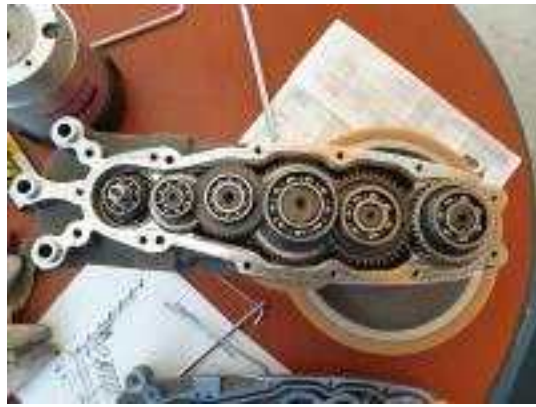
<그림> bogaert 바퀴 동력 구동 기어 내부
