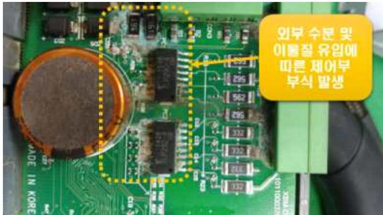
<그림> 기존 방제기 제어부 PCB 부식 현상
