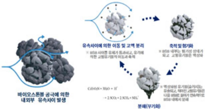
[그림 4-103] 바이오스톤볼을 이용한 접촉산화시설의 정화원리
