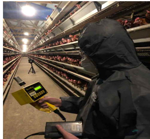
<그림 > 센서 모니터링 수치의 신뢰도 평가를 위한 산란계사 현장 실측 평가
