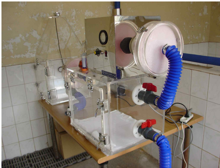
그림 3-73. 실제 제작된 동물 실험용 isolator
