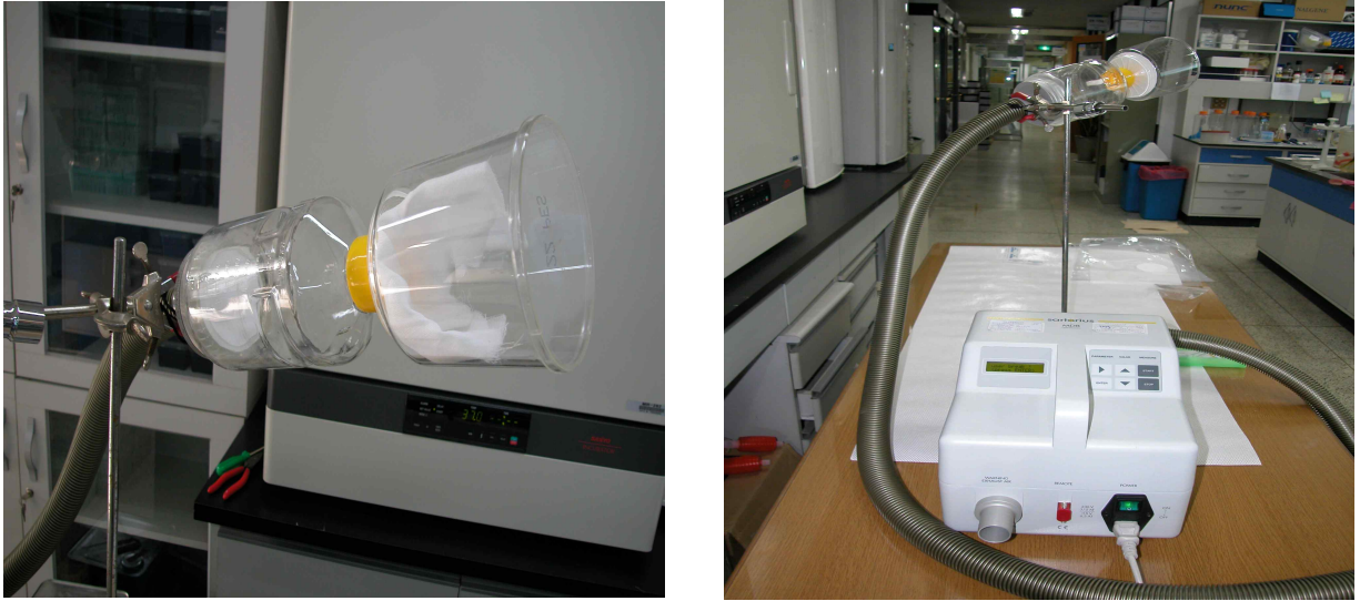
그림 3-62. 바이러스 포집기(Sartorius MD8 Air Sampler) 사진 및 제작한 필터 장착 부분 모식도(A)과 실사진 (B)
