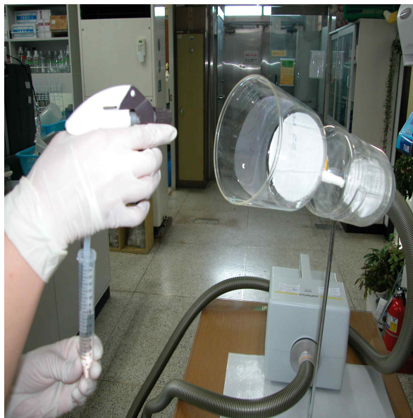
그림 3-63. 바이러스 포집기(Sartorius MD8 Air Sampler) H5N3 바이러스의 분사 실제 사진
