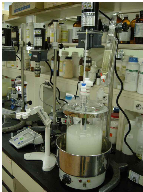
그림 3-2. 키토산/하이드록시아파타이트 복합화 반응장치
