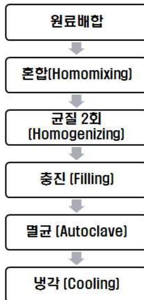
Fig. 2-2. 폐경기 개선식의 lab scale 제조 공정
