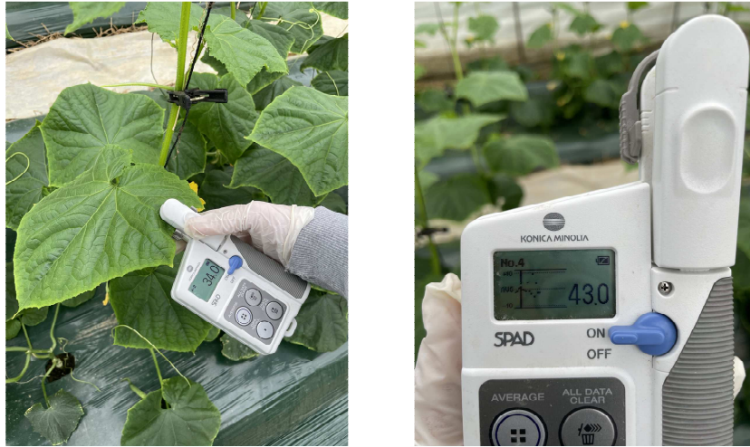
그림 6. 오이의 SPAD (클로로필 함량) 측정 모습 및 화면
