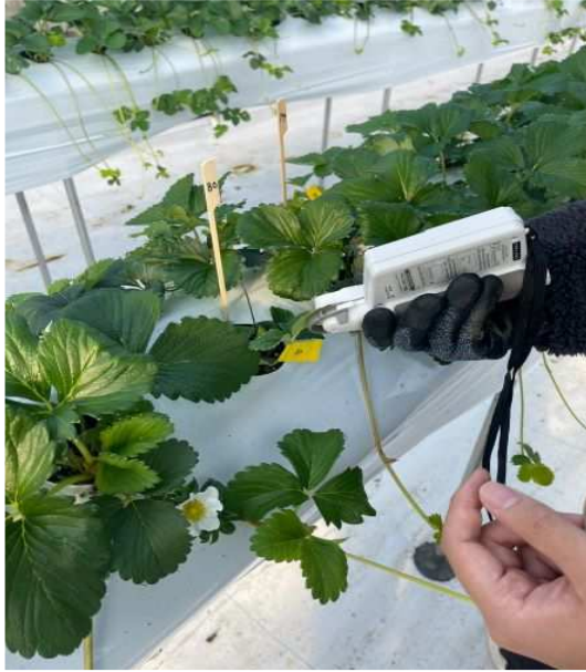
그림 11. SPAD 측정기를 이용한 광학적 생육측정
