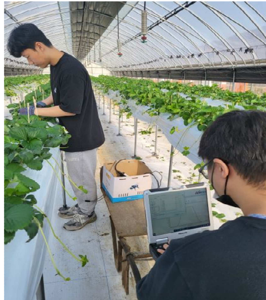
그림 12. 분광스펙트럼 측정기를 이용한 광학적 생육측정
