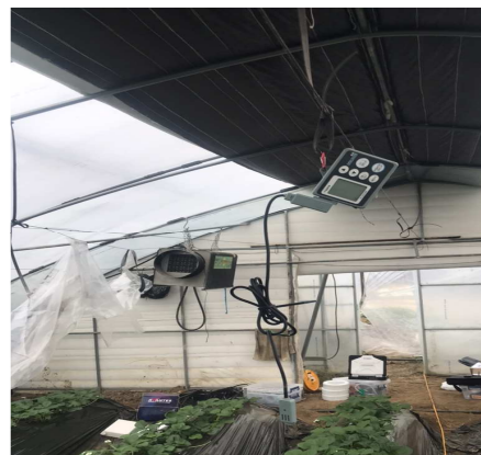
그림 3. 실험용 하우스 내부에서 온습도 센서 및 설치모습
