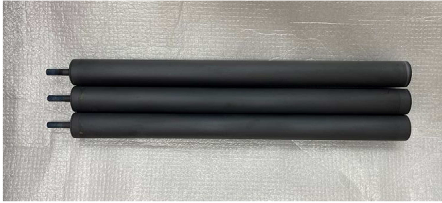
그림 12. Ti grade2 + Ir 5 \mu\text{m} 코팅 플라즈마 히터코어 수명시험 결과
