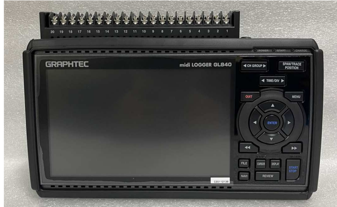
그림 3. 실험용 보일러 가열 특성 분석용 온도 측정기
