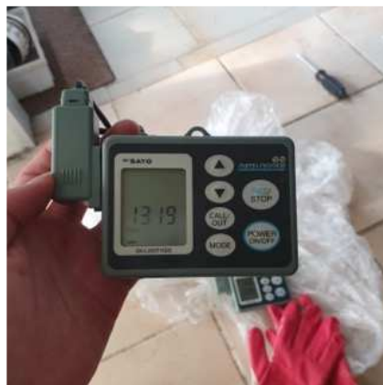
그림 3. 실험용 하우스 내부에서 온습도 센서 및 설치모습
