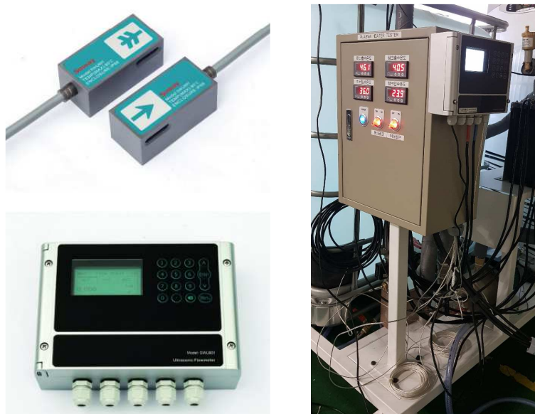
그림 9. 초음파유량계 및 열량계의 복합측정기
