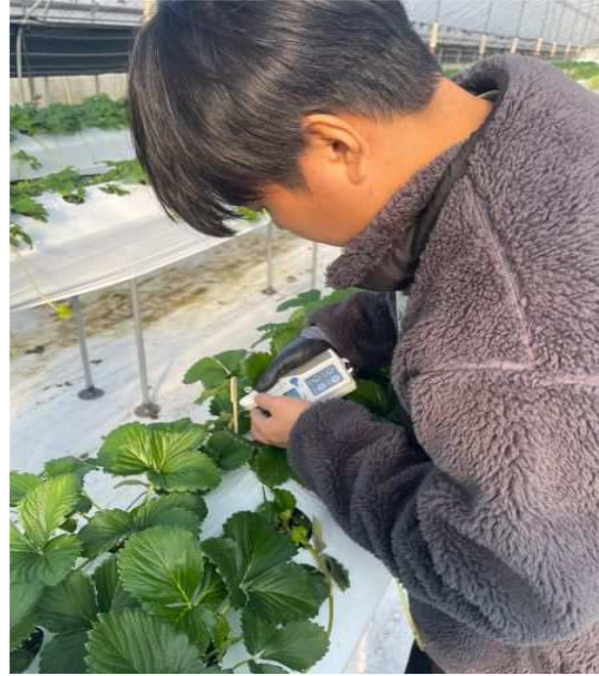
그림 11. SPAD 측정기를 이용한 광학적 생육측정
