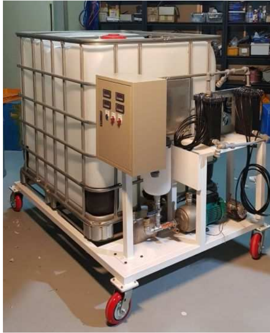
그림 6. 20 kW 급 플라즈마 보일러 히터 유닛 기초성능 시험 장치
