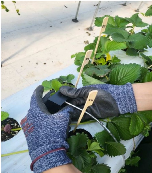
그림 12. 분광스펙트럼 측정기를 이용한 광학적 생육측정
