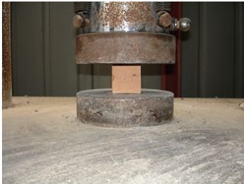
<그림 4-4> 압축강도 시험모습과 결과
