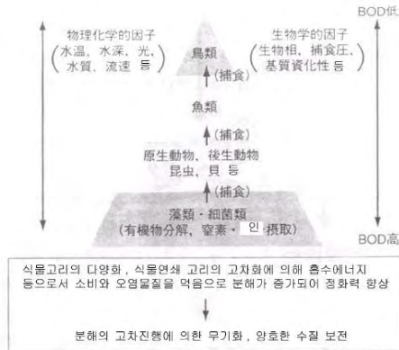
<그림 2-31> 먹이연쇄를 통한 수질정화 효과 모식도
