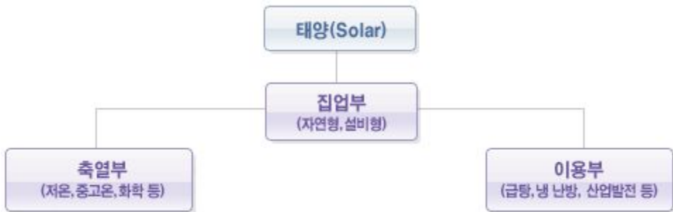
<그림 4.1 태양열 이용시스템 구성도>
