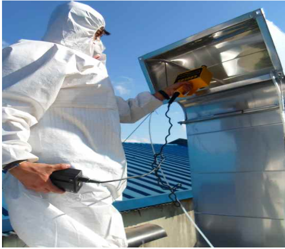
<Fig. 3-7> 축사 공기오염물질 배출계수 산정을 위한 배출구 현장 측정 모습
