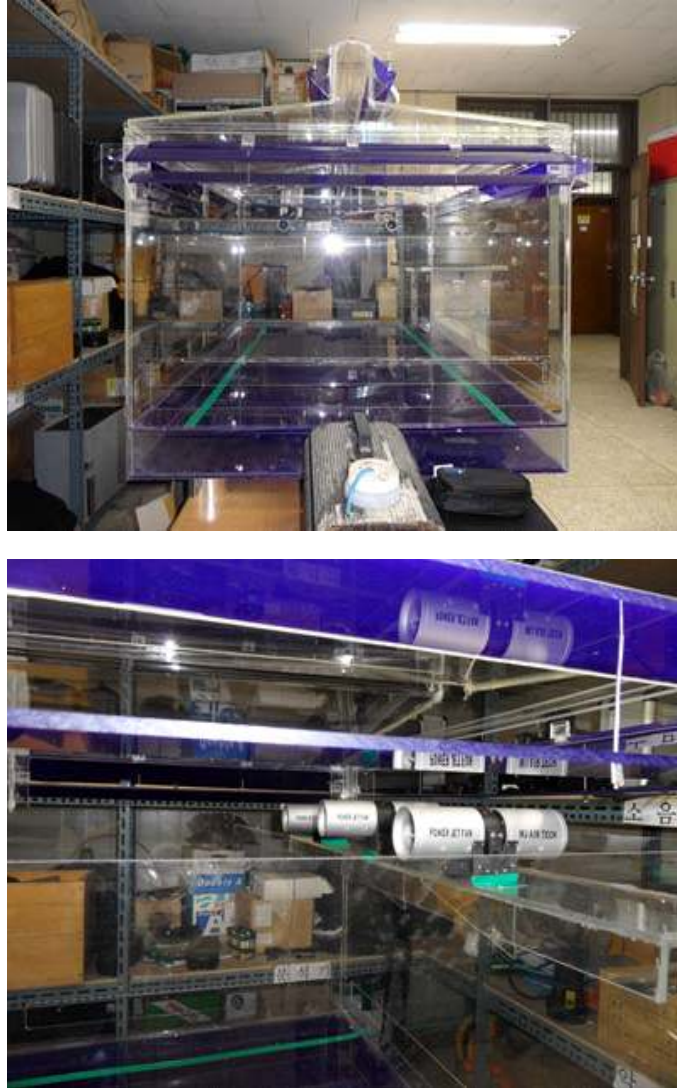
<Fig. 2-44> 제트팬 추가 설치 시의 연구를 위한 모형실험 장치 사진
