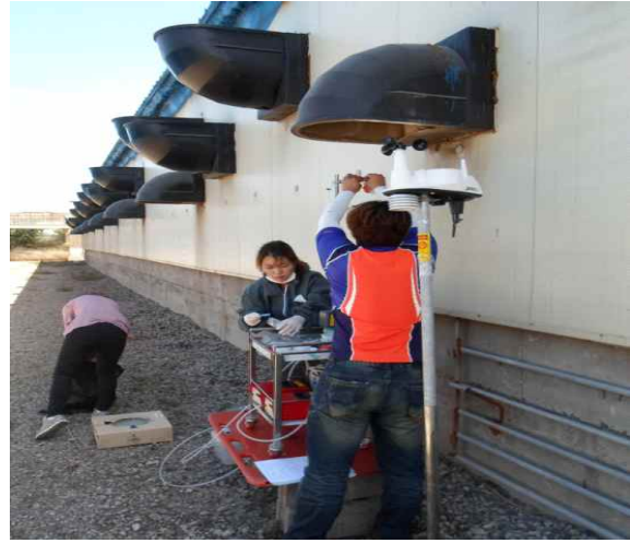
<Fig. 3-7> 축사 공기오염물질 배출계수 산정을 위한 배출구 현장 측정 모습
