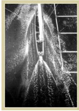
<Fig. 1-17> 미 해군 DTMS 5415 모형시험 장면
