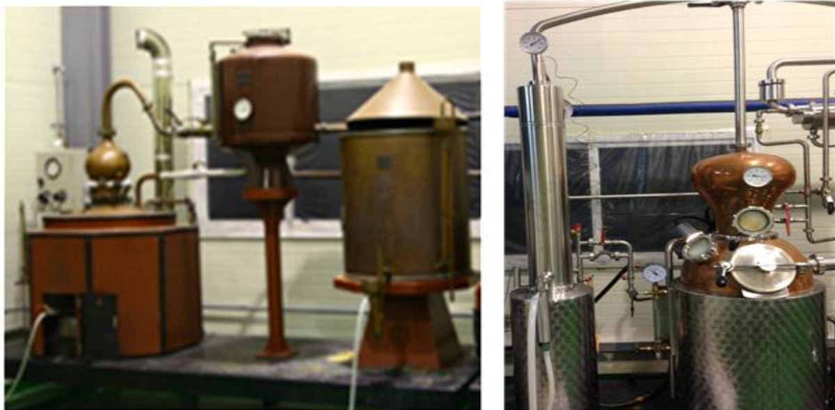
그림 2-54. 실험에 사용할 직부가열방식의 증류기(左)와 간접가열방식의 증류기(右)
