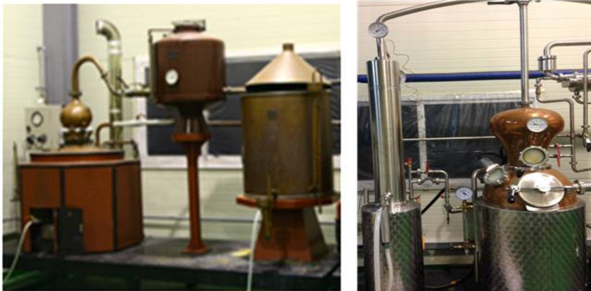
그림 2-19. 실험에 사용할 직부가열방식의 증류기(左)와 간접가열방식의 증류기(右)
