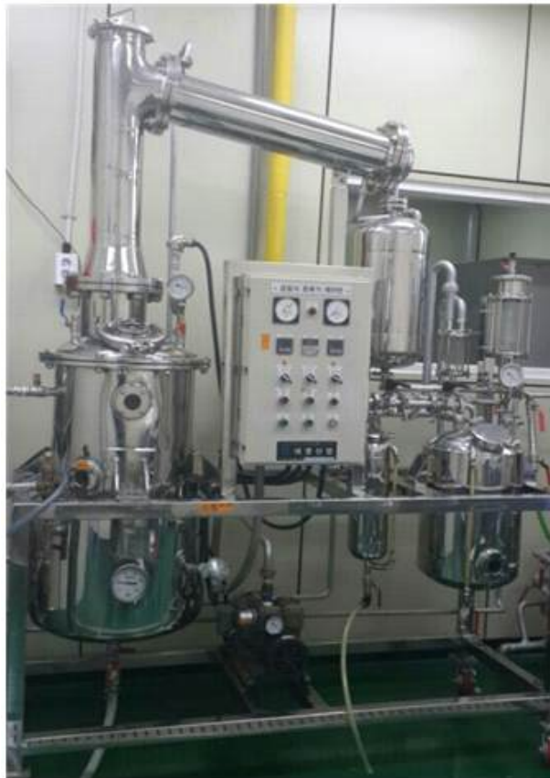
그림 2-14. 본 실험에 사용할 스테인리스 증류기(左)와 동증류기(右)
