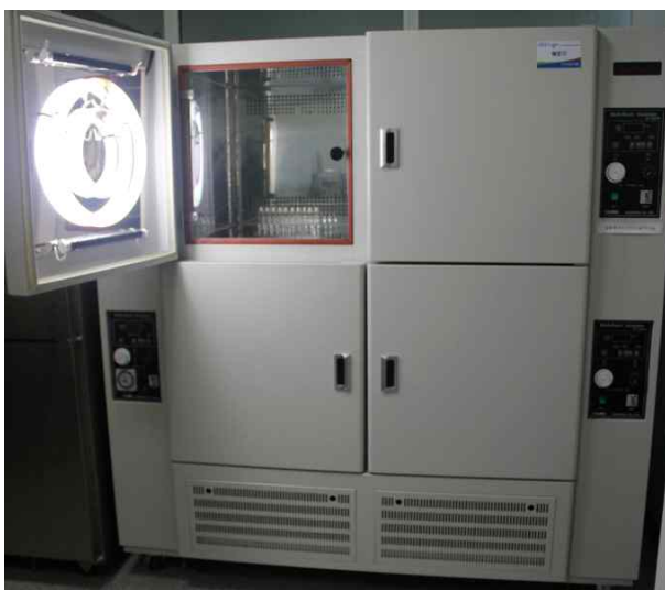
그림 3-62. 빛 노출 시간에 따른 유해물질의 변화를 실험한 인큐베이터
