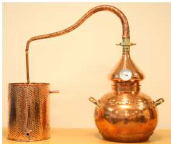
그림 1-33. 본 실험에 사용한 상압 동증류기(가열방식 직부)
