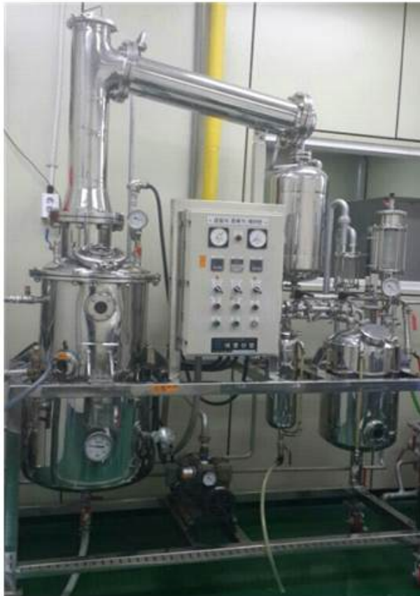
그림 2-49. 본 실험에 사용할 스테인리스 증류기(左)와 동증류기(右)
