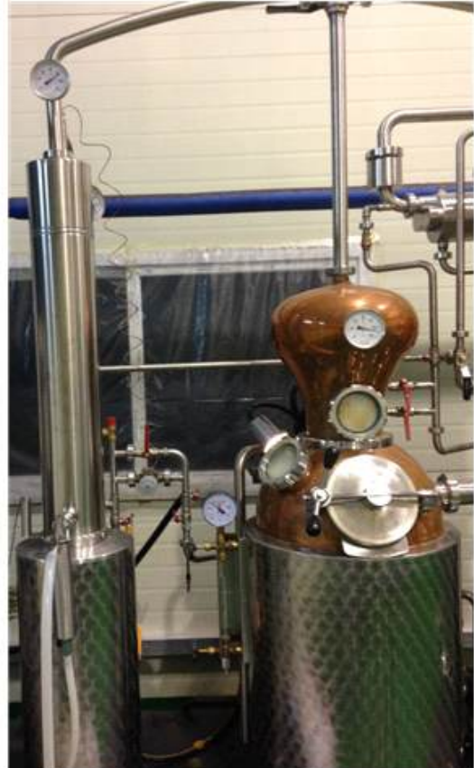
그림 2-49. 본 실험에 사용할 스테인리스 증류기(左)와 동증류기(右)
