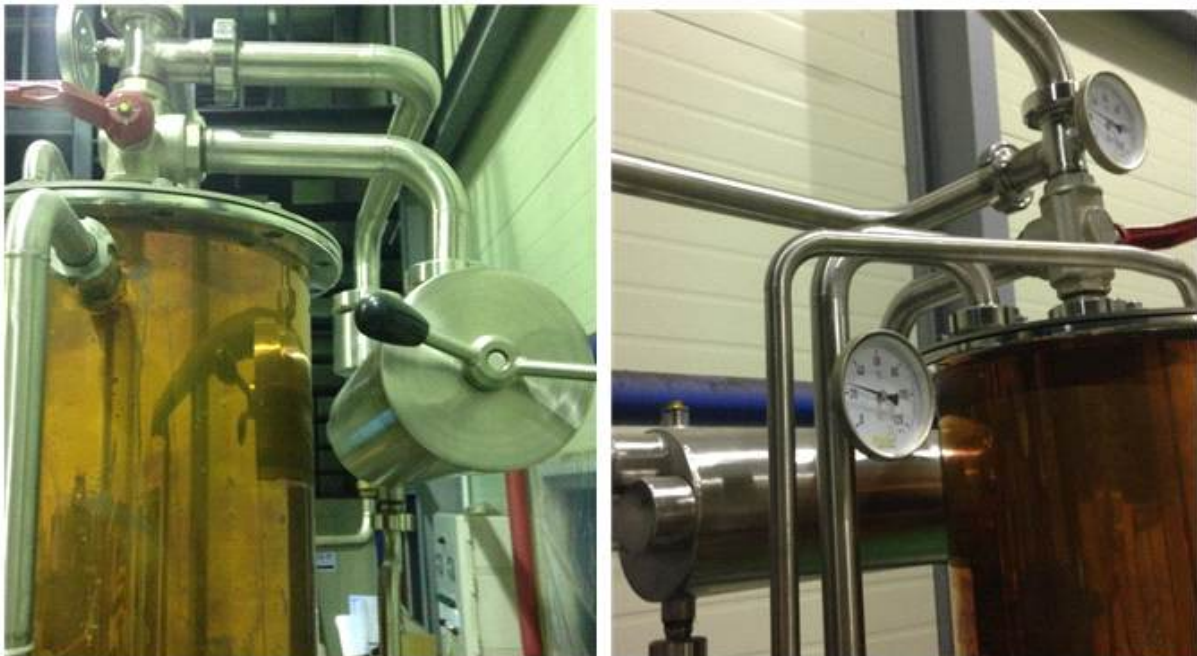
그림 2-102. 단식-연속식 복합 증류기의 구리축매변환장치 및 밸브
