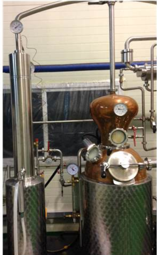
그림 2-14. 본 실험에 사용할 스테인리스 증류기(左)와 동증류기(右)
