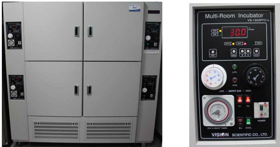
그림 3-53. 저장 온도에 따른 유해물질 분석을 위한 인큐베이터(左) 및 셋팅, 표시장치(右)
