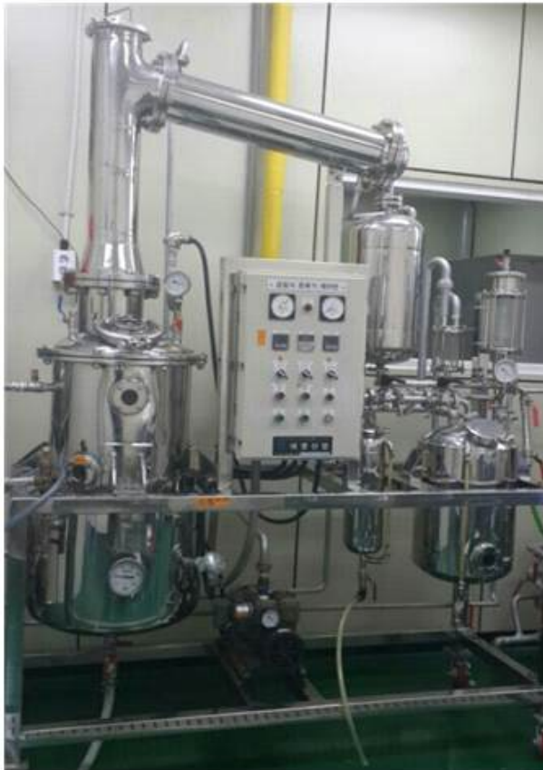
그림 2-90. 본 실험에 사용할 스테인리스 증류기(左)와 동증류기(右)
