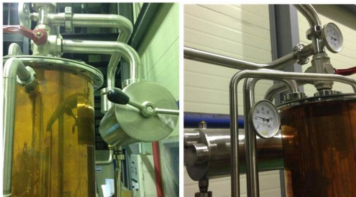
그림 2-61. 단식-연속식 복합 증류기의 구리촉매변환장치 및 밸브
