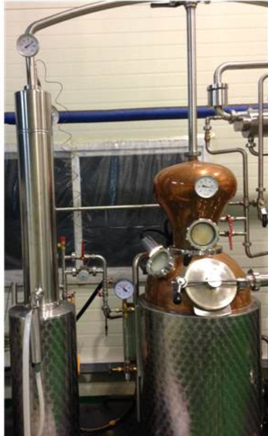
그림 2-90. 본 실험에 사용할 스테인리스 증류기(左)와 동증류기(右)
