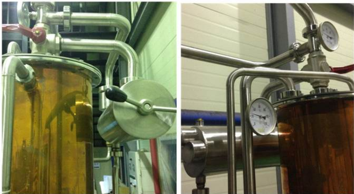
그림 2-26. 단식-연속식 복합 증류기의 구리촉매변환장치 및 밸브
