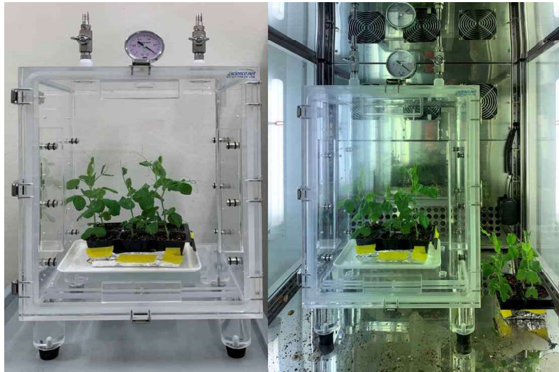
그림 23. 안정동위원소 가스( ^{13}\text{CO}_2 ) 활용 식물 공생 균주 표지 실험
