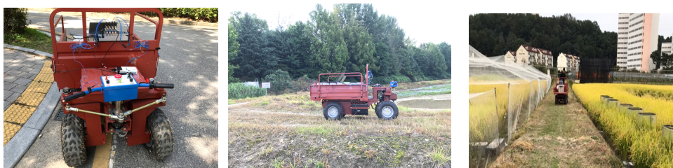
<CNIU온실(충남대학교 부속농장)의 오프로드 조건별 조향시험>
