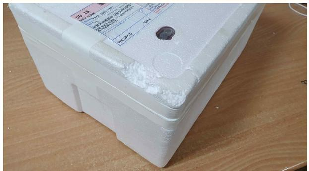
그림 224 개발 용기 (소) 파손 상태
