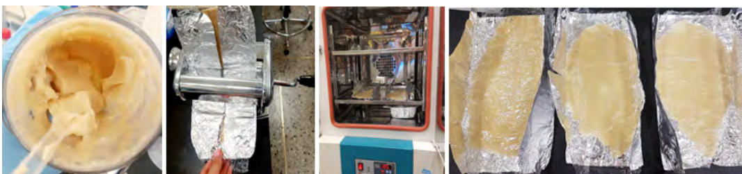
그림 5-13. ISP dough 롤링에 의한 필름 제조 방법
