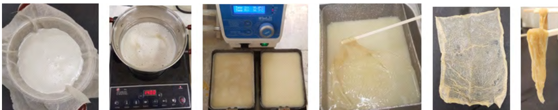
그림 . 표면주조방법에 의한 필름 제조 공정
