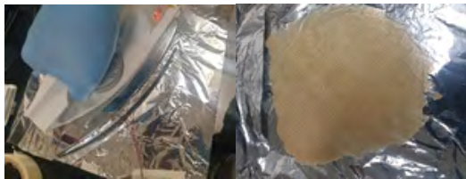
그림. Hot-press에 의한 조직 고정화 공정에 의한 필름 제조
