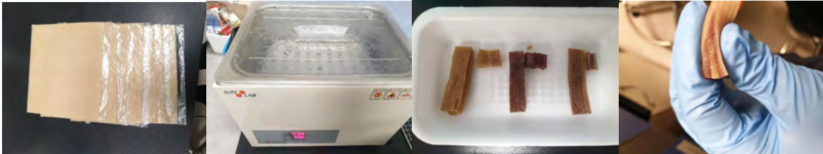
그림. 단백질필름의 증기 열처리에 의한 접합 과정
