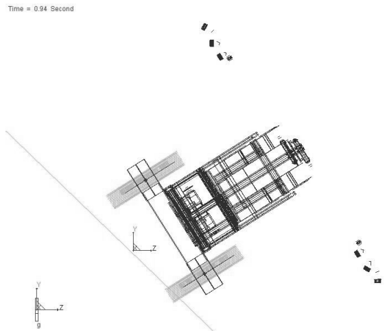
그림 7-61 일반형 무인방제기의 안정성 분석(direction-90°, ground-43°, 0L)
