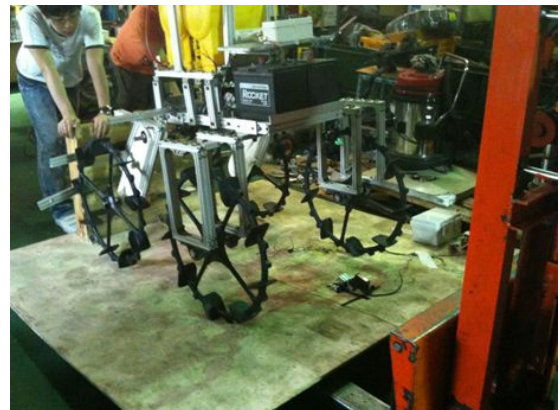
그림 10 가변형 차륜 모델 등판성능 시험
