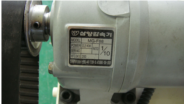
그림 31 1차년도 시작기에 사용된 교반날 회전축 감속기
