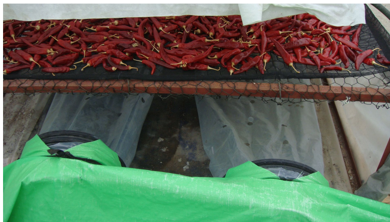
그림 17 Bed 하부 온풍 공급을 위한 열풍 덕트의 배치
