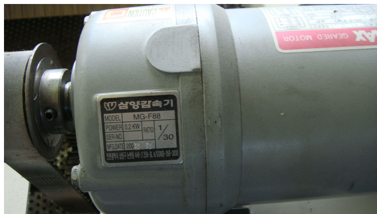
그림 30 1차년도 시작기에 사용된 구동축 감속기
