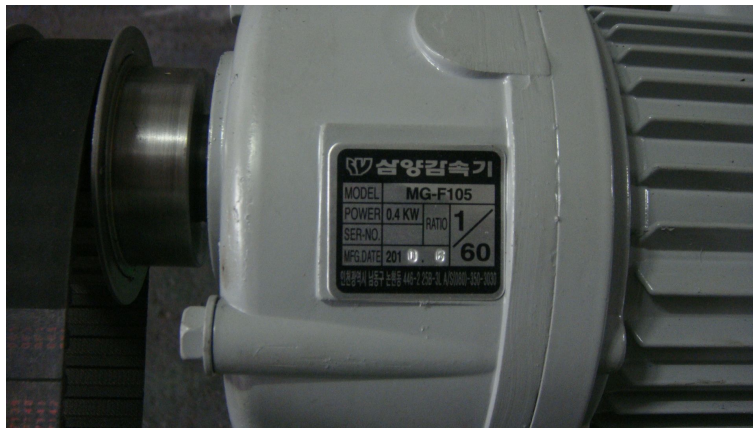
그림 32 2차년도 시작기에 적용된 시스템 이송모터 감속기
