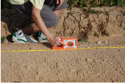
그림 4 경사지의 각도 측정
